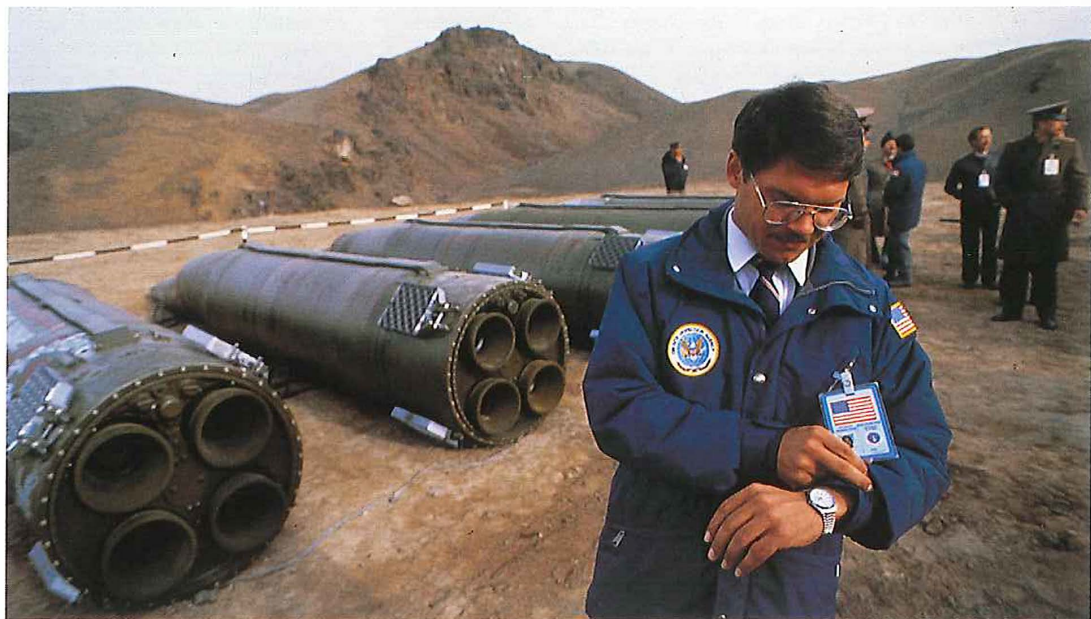
Sovjetiska SS-23-robotar i väntan på att bli förstörda enligt INF-avtalet. SS-23 var en ballistisk robot med längden 7,5 m, vikten 4 ton och räckvidden 500 km. Den kunde förses med en 100 kt stridsdel men även konventionella eller kemiska stridsdelar.
