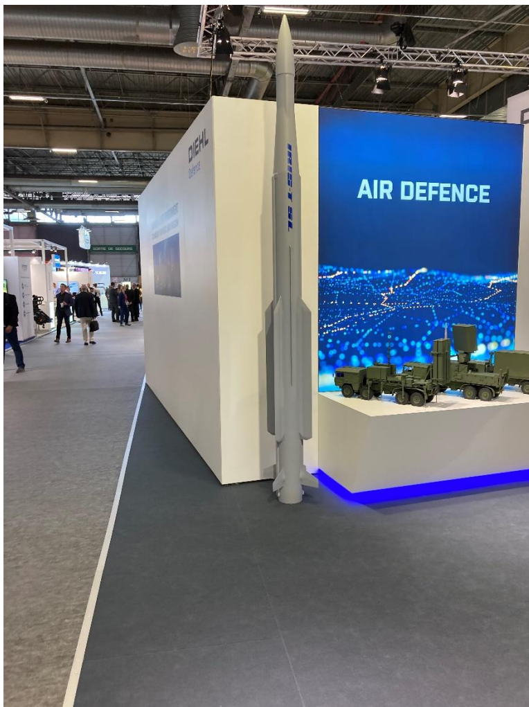
Figur 3. IRIS-T SL, en längre variant av IRIS-T, särskilt utvecklad för vertikal avfyring från marken. (Rb 98 som avfyras vertikalt från Bv410 är inte av denna typ; den är samma Rb98 som bärs av Fpl 39 Gripen, dvs. standard IRIS-T).
