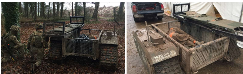
Figur 1: Exempel på en medeltung UGV (MILREM TheMIS) med logistiknyttolast som utrustats med bår för okvalificerad sjuktransport. Foto: FOI.
