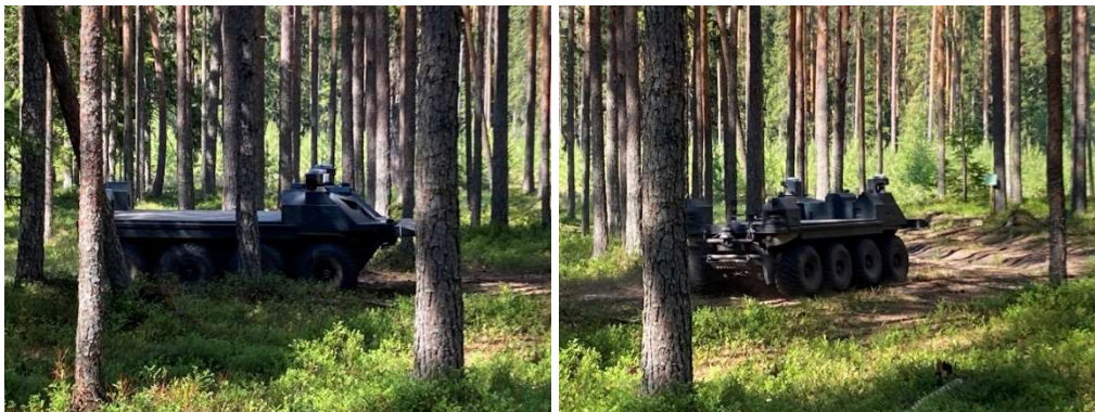
Figur 3: Rheinmetall Mission Master SP vid autonom körning i skog under UGV Autonomy Trials i Estland i juni 2023. Detta är ett exempel på en mångfunktionell medeltung UGV, med modulära nyttolaster, där logistikuppdrag och CASEVAC ofta beskrivs som passande användningsområden. Foto: FOI.
