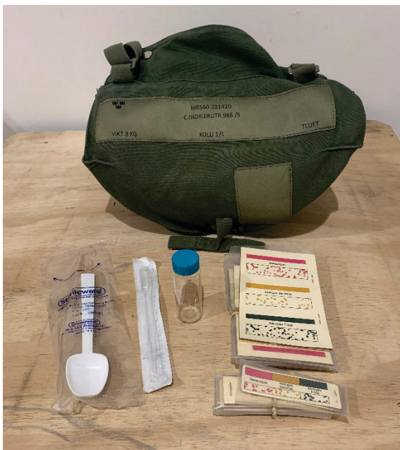
Figur 1. Delar av FM C-indikeringsutrustning 98B /S avsedd för manuell indikering och provtagning av kemiska stridsmedel. Från vänster till höger: provtagningssked, plastpipett, 40 ml medicinflaska (vial) samt indikeringspapper. FOTO: FOI
