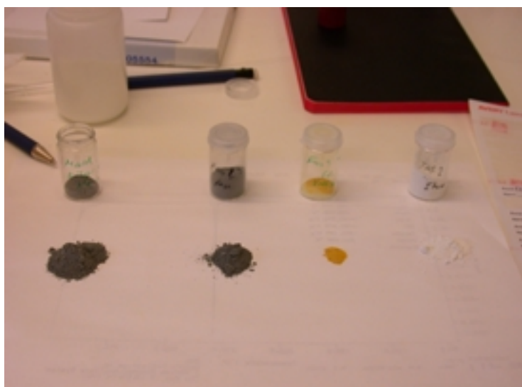
figur 6: Bild på de olika faserna efter indunstning och torkning. Från vänster i bild opåverkat krut, metallpulver(fas 3), nitrater(fas1), hexakloretan(fas 2).
