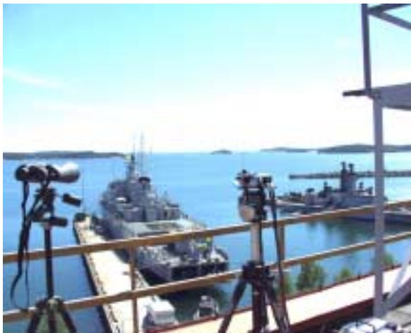
Figur 4. Utsikt från taket på den byggnad där lasern placerades. Till höger en bild tagen genom laserns siktesoptik. På den Ö (lilla Eggskär) som kan ses i siktesoptiken var mätutrustningen för detektering av laserstrålningen placerad.
