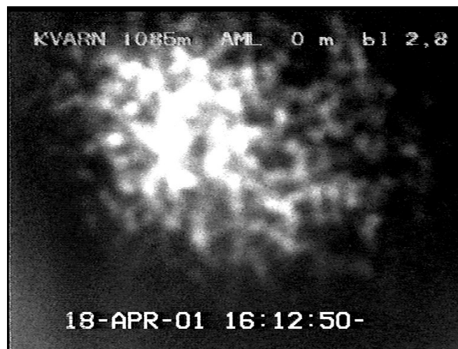
Figur 3. Tvärsnitt av en laserstråle, filmad då den propagerat 1085 m i atmosfären.
