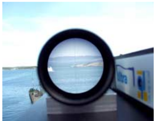
Figur 4. Utsikt från taket på den byggnad där lasern placerades. Till höger en bild tagen genom laserns siktesoptik. På den Ö (lilla Eggskär) som kan ses i siktesoptiken var mätutrustningen för detektering av laserstrålningen placerad.
