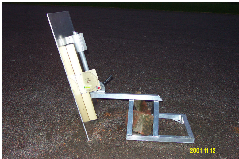
Figur 25. Rektangulär platta under radarmätning på grusplan i Ryd.
