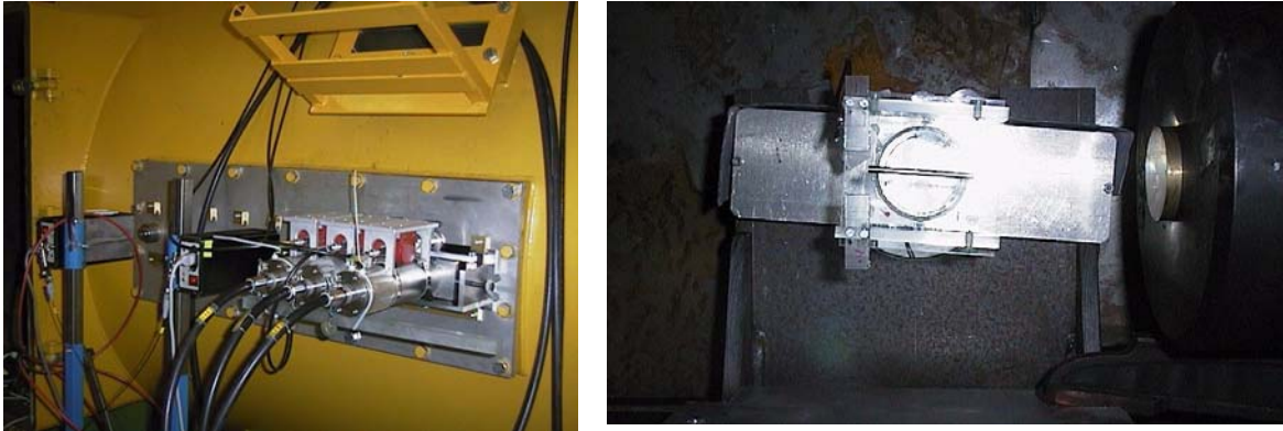
Figur 7. Röntgenblixtrar monterade på måltankens utsida och filmkassett inne i tanken.
