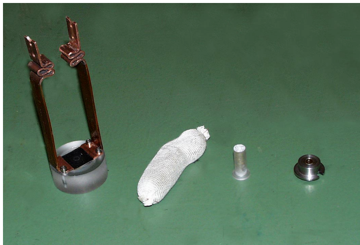
Figur8. Från vänster: hållare med limmad testladdning (svart) inklämd mellan elektroderna samt tillredare (utan silikonisolering), tygpåse med boosterkrut, tändladdning och tändhatt i hållare.
