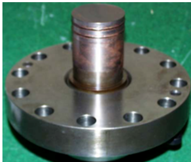
Figur 12. Bombens bakgavel med o-ringsförsedd utfyllnadskropp.
