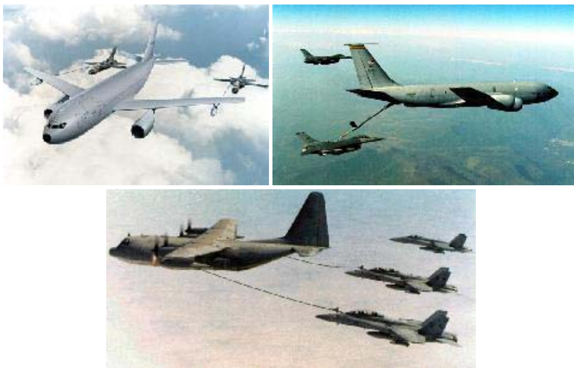
Figur 24. Olika lufttankningsflygplan och lufttankningssystem. I övre raden den tyska Multi-role Tanker Transport (MRTT), baserad på Airbus A310, och det amerikanska flygvapnets KC-135, baserad på Boeing 707. I nedre raden den amerikanska marinkårens KC-130, en lufttankningsversion av Hercules (kan även lufttanka helikoptrar). Notera de olika lufttankningssystemen: KC-130 och A310 har slangsystem för att tanka F-18 resp. Tornado, medan KC-135 använder bom för att tanka F-16.
