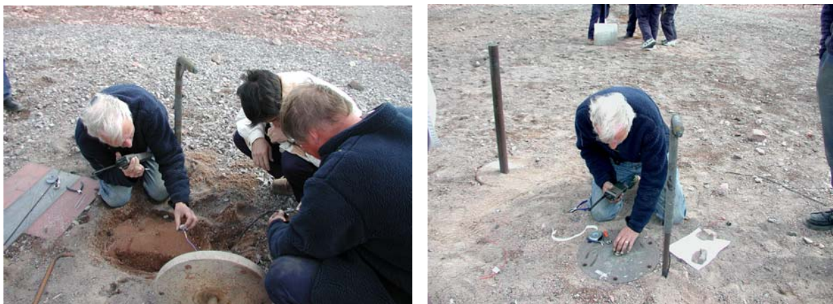
Figur 3. Markgivararrangemanget och stånggivare
