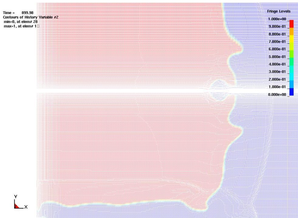
Figur 10. Luftinneslutning under reaktionsprodukterna vid simulering av skott 5. Rött område anger reaktionsprodukterna medan blått område anger luft. Uttagen ruta har dimensionerna höjd 1.7 m, längd (radie) 2 m.
