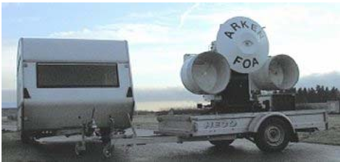
Figur 1. Radarmätsystemet Arken. På bilden syns husvagnen innehållande datainsamlings- och databearbetningsutrustning. Monterat på släpvagnen är antennenheten, med mäntantennerna och antenn för målföljning.
