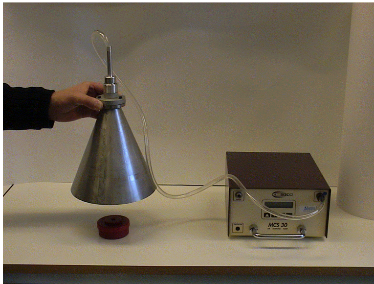
Fig. 9 Provtagare 1 ansluten till provtagningssträtt och batteridrivna luftpump.
