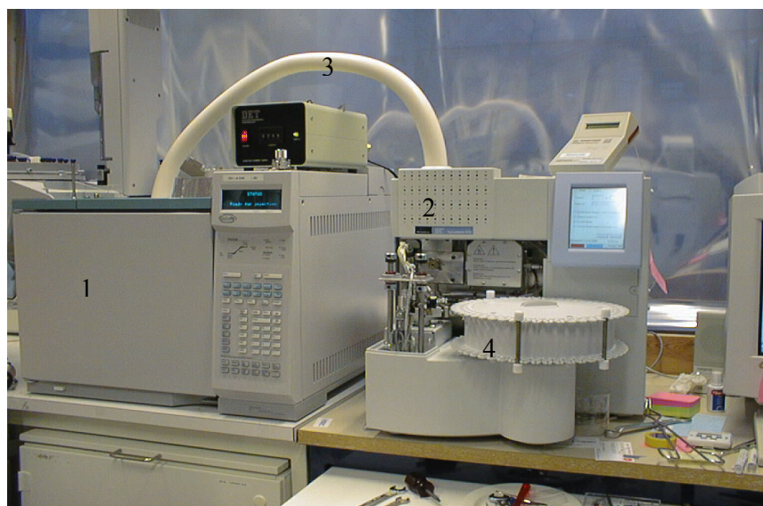
Fig. 2 TD-GC system, 1) Gas kromatograf, 2) Termisk desorption, 3) Transfer line, 4) Provtagningsrör och provväxlare
