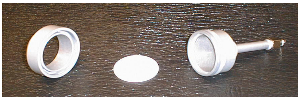
Fig.11 Provtagare 2 med filter
