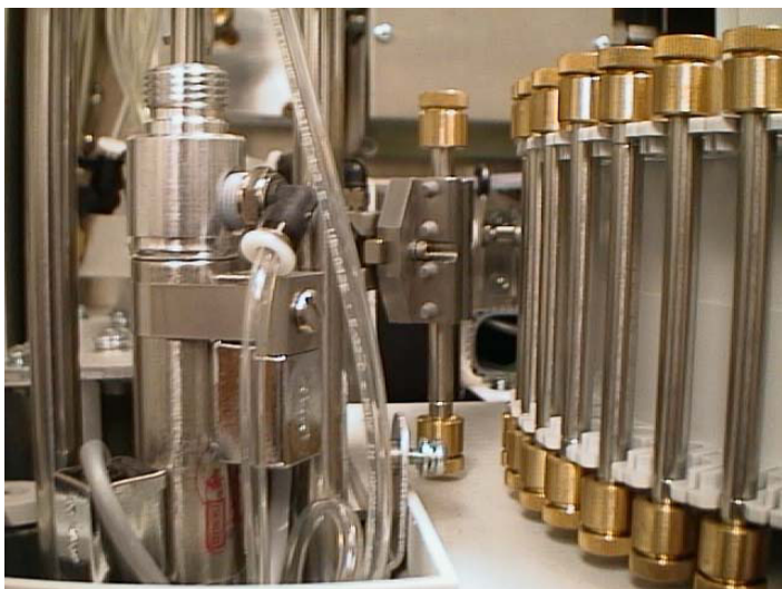
Fig. 5 Provkarusell samt provväxlare
