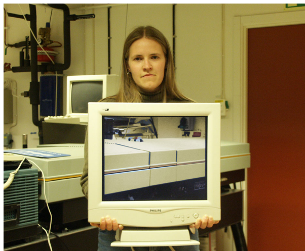
Figur 5.1. Principbild för hur kamouflage med bildskärm kan fungera.
