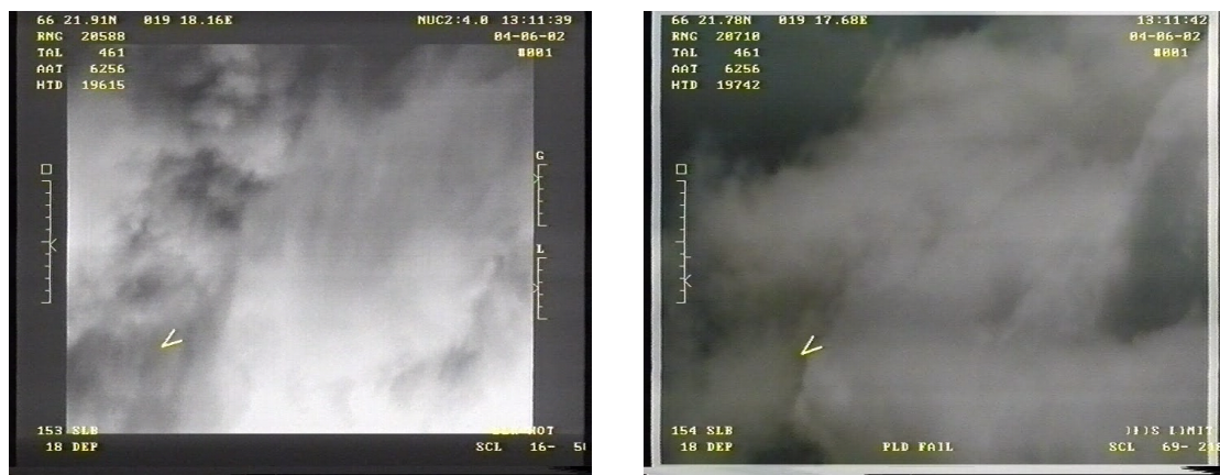
Figur 10. Moln på 6 km flyghöjd förhindrade markspaning med de optiska sensorerna på Eagle UAV under två av tre flygtillfällen. Exempel på IR- (vänster) och TV-bild (höger) under molniga förhållanden.
