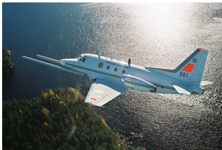
Figur 1. FMV:s provplattform TP86 används som bärare för både CARABAS-II och LORA. De två 5 m långa rören som sticker ut framför flygplanets nos innehåller respektive radarsystems antenner. I CARABAS innehåller rören två stycken identiska bredbandiga dipoler för 20-90 MHz. I LORA, däremot, innehåller vardera rör en gruppantenn bestående av fem stycken bredbandiga dipoler avstämde för 200-400 MHz respektive 400-800 MHz. CARABAS-II och LORA kan f.n. inte installeras samtidigt. (Foto: FMV VoVC, Pia Ericson)
