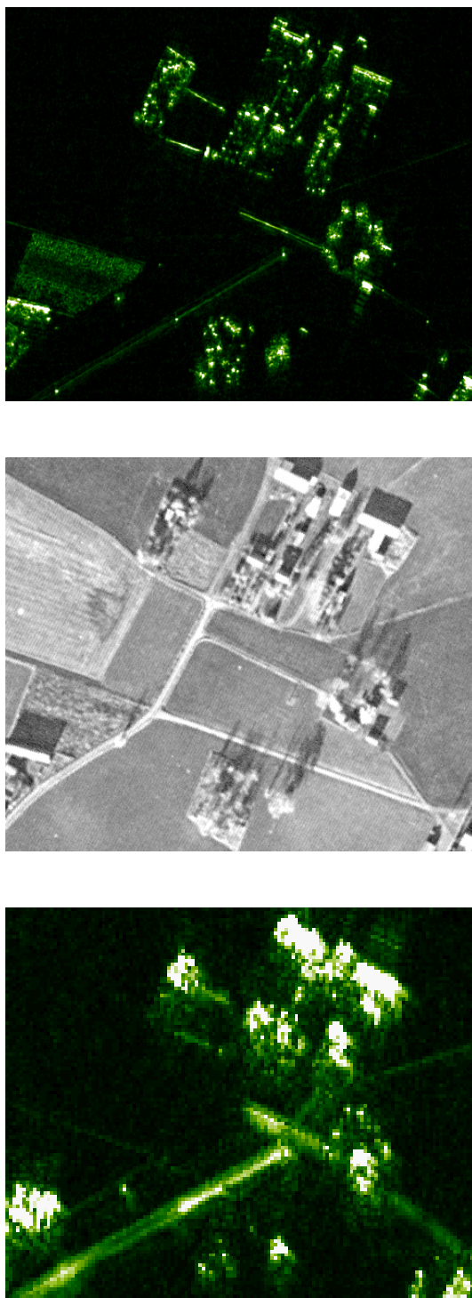
Figur 9. Jämförelse mellan LORA SAR-bild 219-420 MHz (övre), flygfoto (mitten) och CARABAS-II SAR-bild 22-82 MHz (nedre) över norra delen av Visingsö. Flygfotot visar ett flertal byggnader och träddungar. I CARABAS-bilden syns enbart de största strukturerna inklusive två kraftledningar som löper diagonalt över bilden. LORA-bilden har betydligt bättre upplösning (0.7 m) och mindre objekt syns därmed tydligare. Notera speciellt det ojämna markområdet nere till vänster i flygfotot som syns i LORA-bilden men är mörkt i CARABAS-bilden p.g.a. den större våglängden relativt ytans skrovlighet. Bildstorleken är 0.4 km x 0.4 km.
