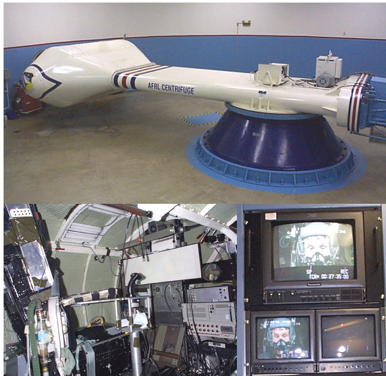
Figur 4. Humancentrifugen vid Brooks Air Force Base med insidan av gondol med sittplats och exempel på kamerabild av försöksperson presenterat i kontrollrum.
