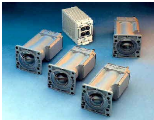
Figur 5. Robotskottvarnare från Sydafrikanska Avitronics är ett exempel på nu tillgänglig varnare baserad på UV-teknik. Varje enskilt varnarhuvud har ett synfält på ca 100°. Genom att kombinera lämpligt antal moduler, normalt 4 st, erhålles önskat täckningsområde.
