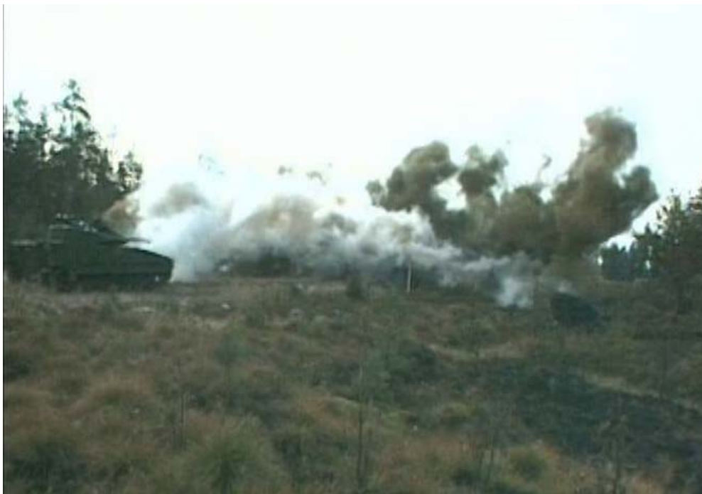
Figur 10. Närskyddsrok utlagd från strf90. Rökgranaterna skjuts ut ca 30 meter från fordonet innan de exploderar och röken börjar utvecklas.
