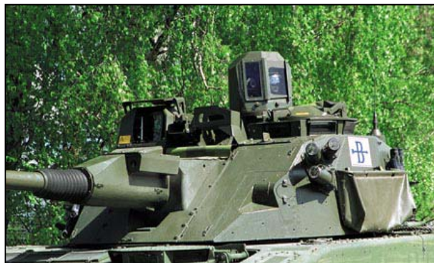
Figur 9. Tre stycken rökkastare för närskyddsrok monterade på sidan av tornet till strf90.
