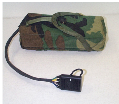
Litium engångsbatteripack med påsebatterier (pouch) tar liten plats och väger mindre än batterier på cylindrisk form
