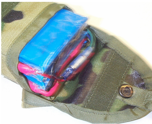
Litium engångsbatteripack med påsebatterier (pouch) tar liten plats och väger mindre än batterier på cylindrisk form
