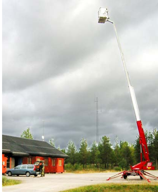
Figur 5. Simulering av UAV för fysisk insats skedde genom fjärrkontrollerad webbkamera monterad på skylift på övningsområdet, i anslutning till G1 värmestuga.
