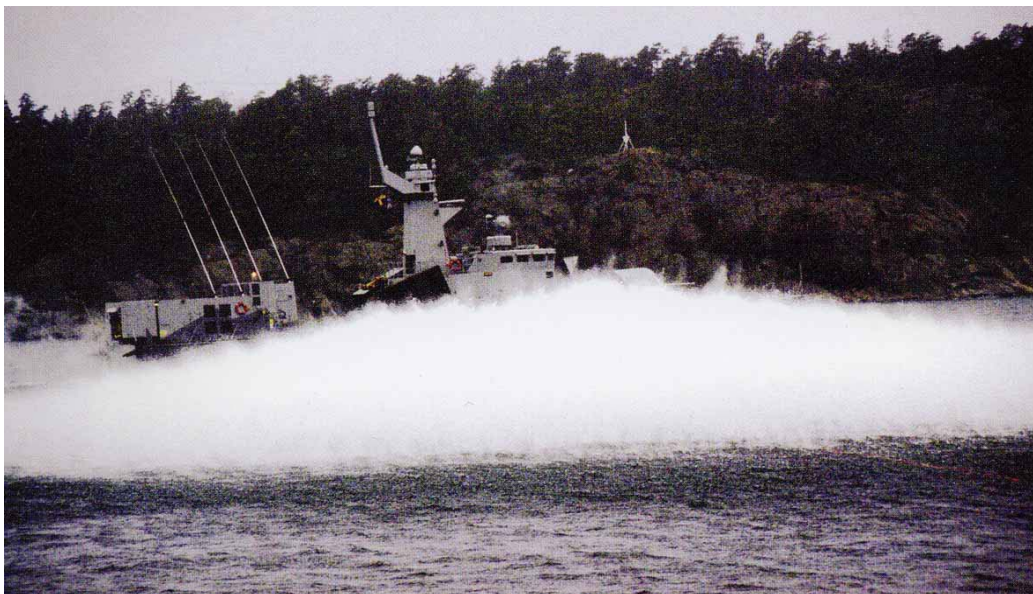
Figur A1- 1, Sprängprov mot Kv Stockholm: Leveransprov av stötdimensionering
