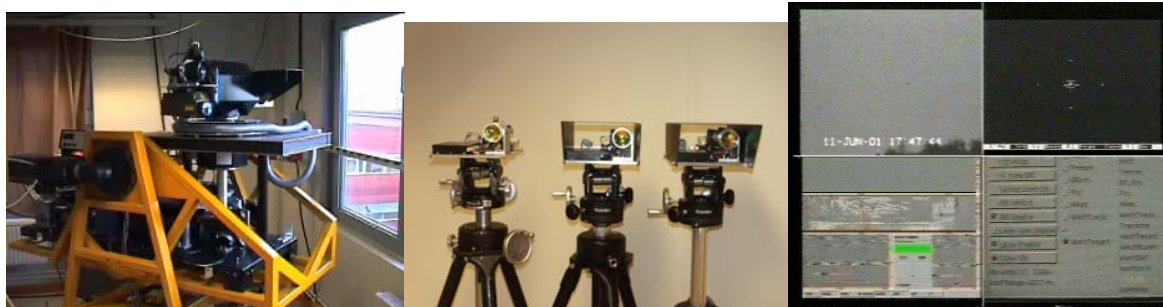
Figur 2.9: Illustration av nivå 2 DIRCM-värdering , f. v. LYSA monterat på vridbord, målsökarattrapper samt bild från LYSA systemets presentationsenhet i fältprov mot flygburna mål.
