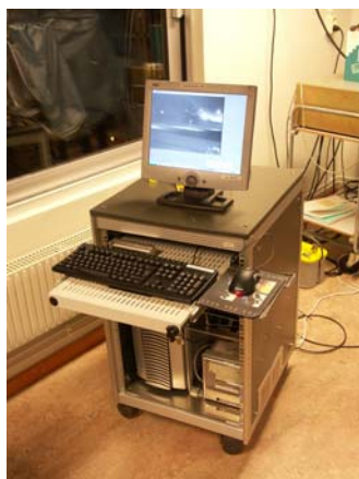
Figur 3.7: Datorkabinett med två PC-datorer med bland annat vidomålföljarsystemet LinovaTracker installerat.
