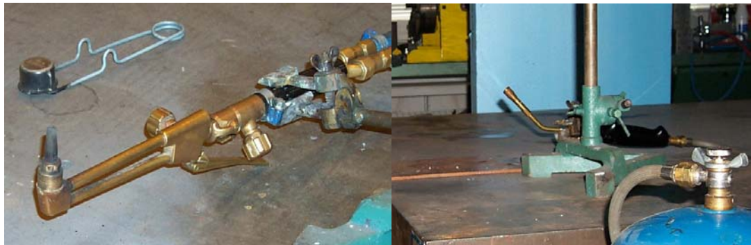
Figur 4.5: Gassvetsmunstycke (t.v) och gasolbrännarmunstycke med lågor.
