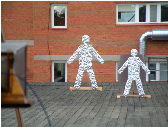
Figur 14: T.v. Två metallfolieklädda träfigurer av olika storlek är utplacerade på olika avstånd från sändaren. T.h. Figurerna återfinns i mitten av avståndsprofilen i form av två toppar. Toppen längst till höger är vägen på huskropp Q.
