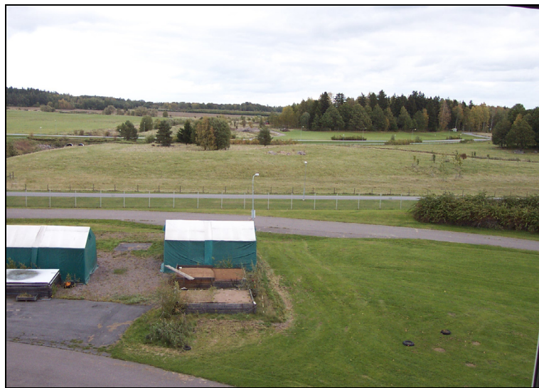
Figur 12: Foto på mätsträckan för experiment mot mark. I bilden syns tält, lyktstolpar, staket m.m. och dessa ger några av de ekon som erhålls i en del av de mätningar som gjordes i denna riktning.
