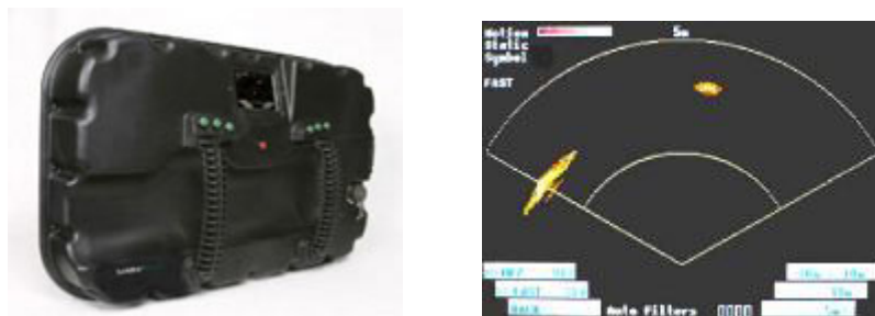
Figur 3. Till vänster visas TimeDomains SoldierVision-system. Notera displayen nära kanten. Den högra bilden ger ett exempel på hur två objekt i rörelse framträder på olika positioner i operatörens display.
