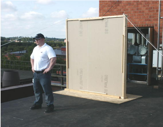
Figur 17. Mätuppställning med radarregistrering av person bakom gipsvägg.
