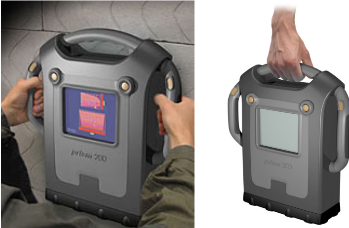
Figur 9. Operatören håller systemet stilla mot väggen. Efter ca 2 sekunder erhålls en 3D-avbildning av pågående aktiviteter. Källa: http://www.cambridgeconsultants.com/news_pr150.shtml
