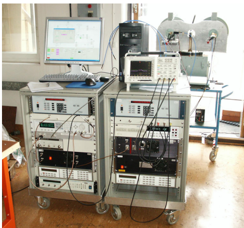
Figur 16. Mätssystemet med styr- och registreringsutrustning, samt vridbord med sändar- och mottagarantennerna.
