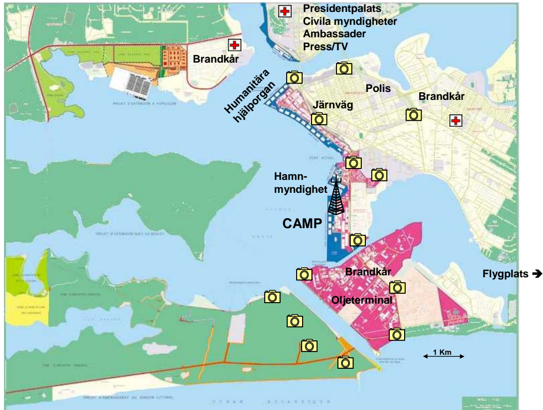
Figur 7 Teknisk lösning för år 1. En 802.16 basstation monteras i en mast i campen. Varje kamerasymbol utgörs av en 802.16-klient samt en eller flera kameror. Runt varje klient kan flera kameror med 802.11 placeras ut.
