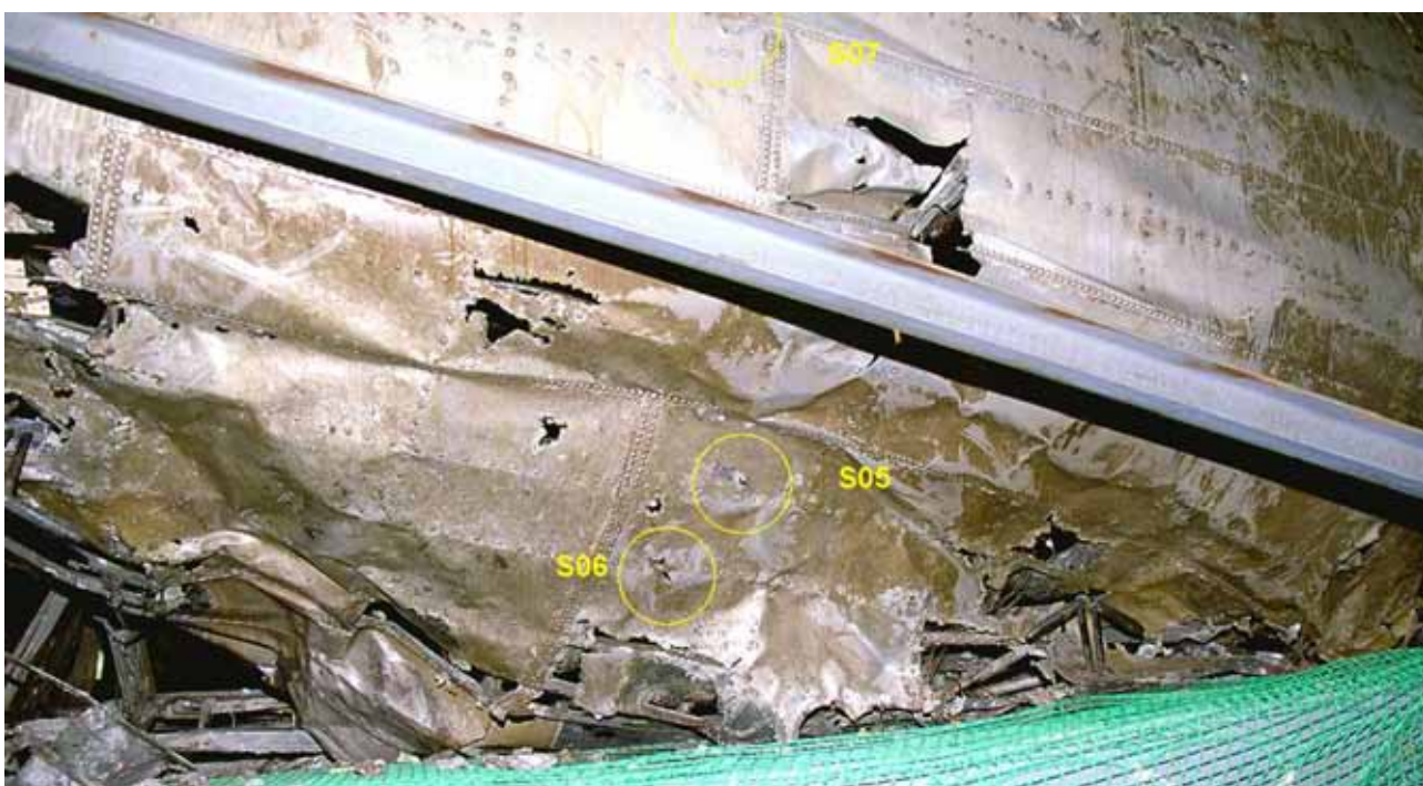
Figur 13 Utgående splitterskador, kroppens undersida höger bak, sannolikt härrörande från brisad i S04
