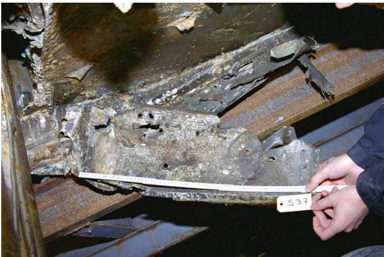
Figur 45 Omfattande splitterskador S37 i lossliten plåt vid landningsställsstötta bakom höger hjulhus
