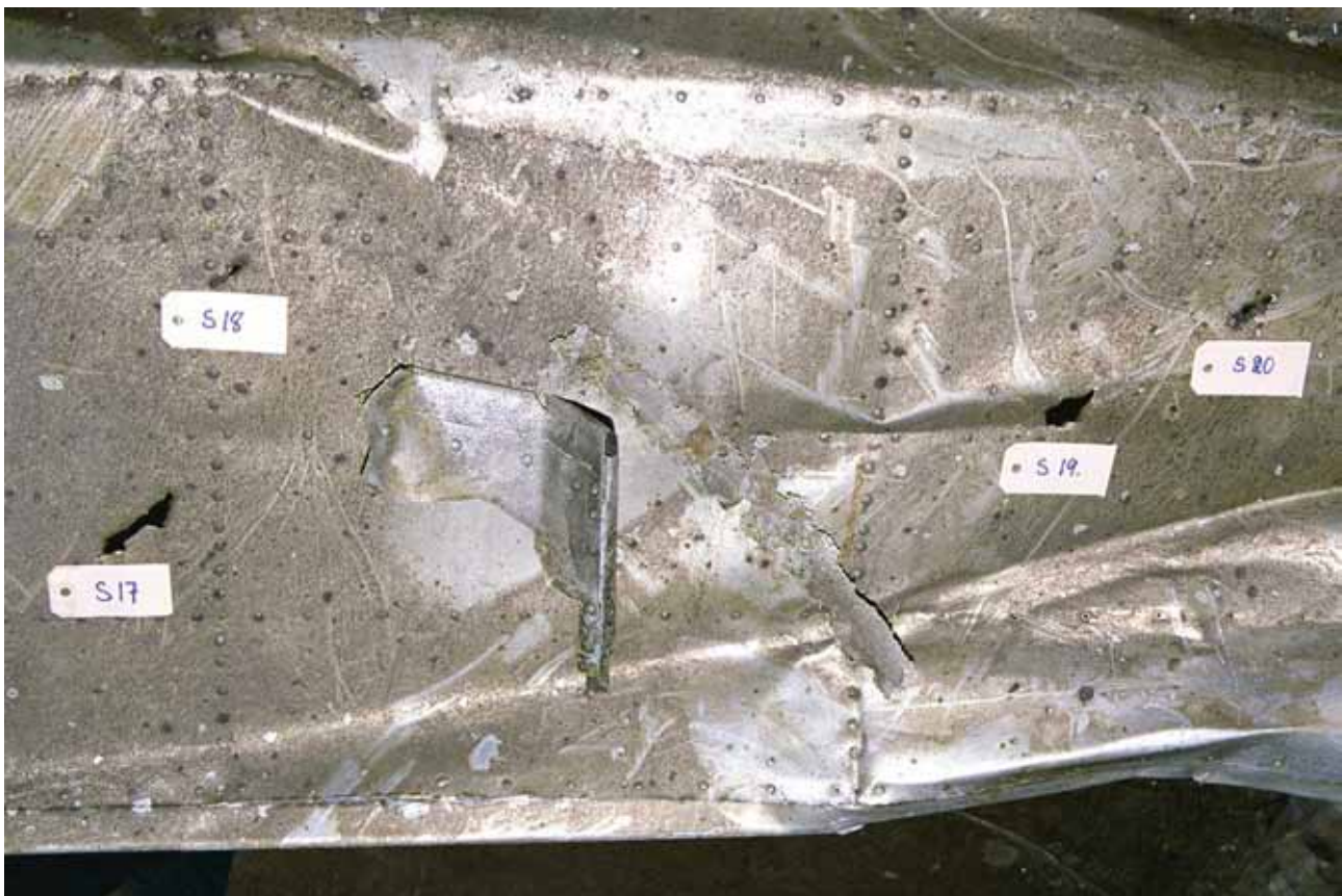
Figur 24 Detalj, splitterskada S17-S20
