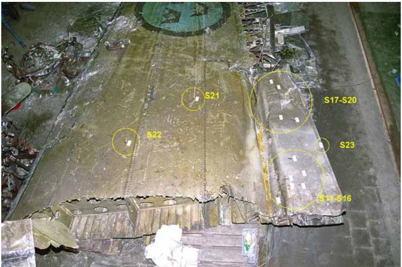
Figur 22 Översikt, splitterskador S11-S23 i höger vinges ovansida utanför kapning genomförd vid bärgning
