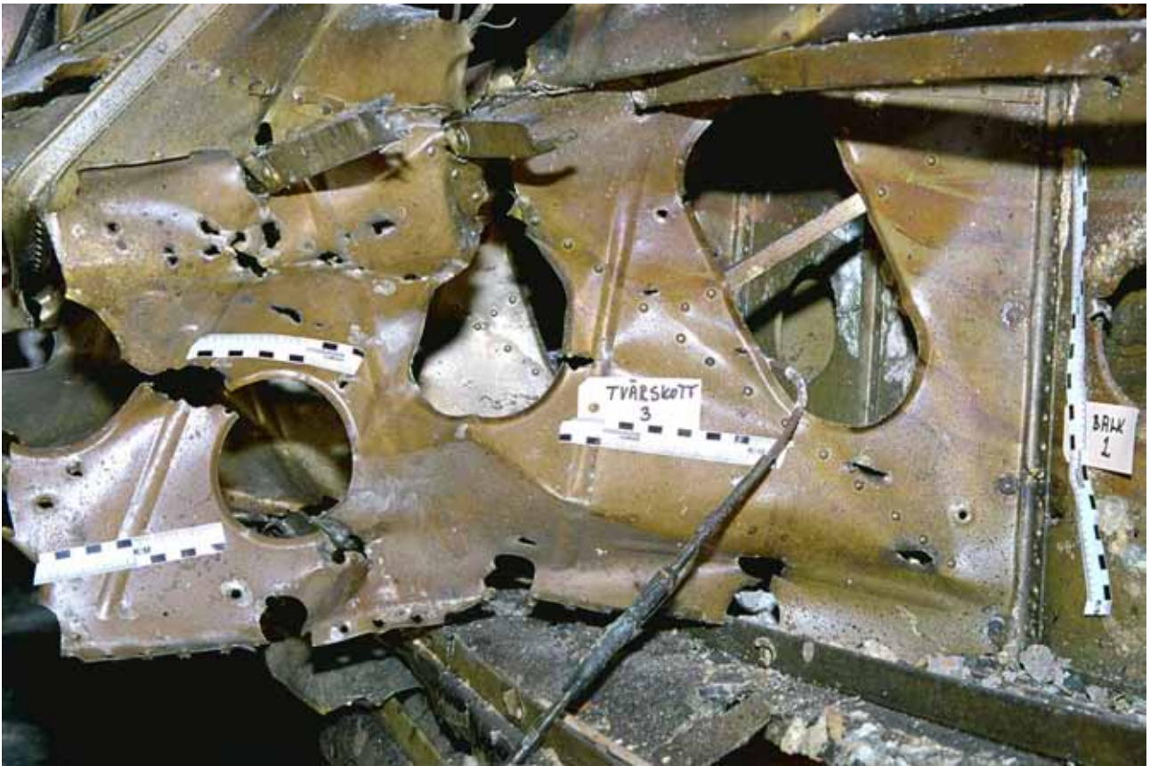
Figur 52 Detalj 2, brisadnära splitterskador S53, vänster vinges bakkant
