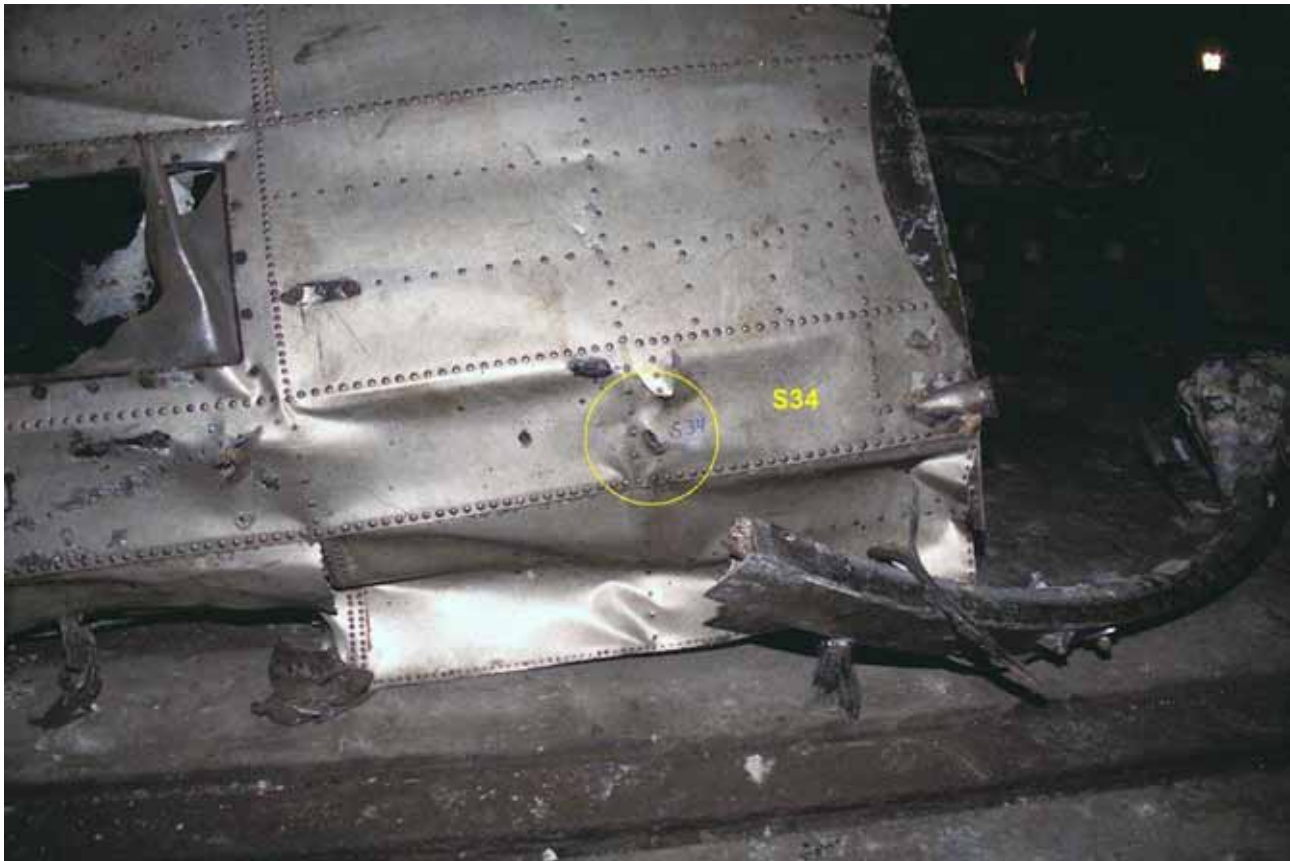
Figur 39 Utgående splitterskada S34, vänster sida framför lastdörr
