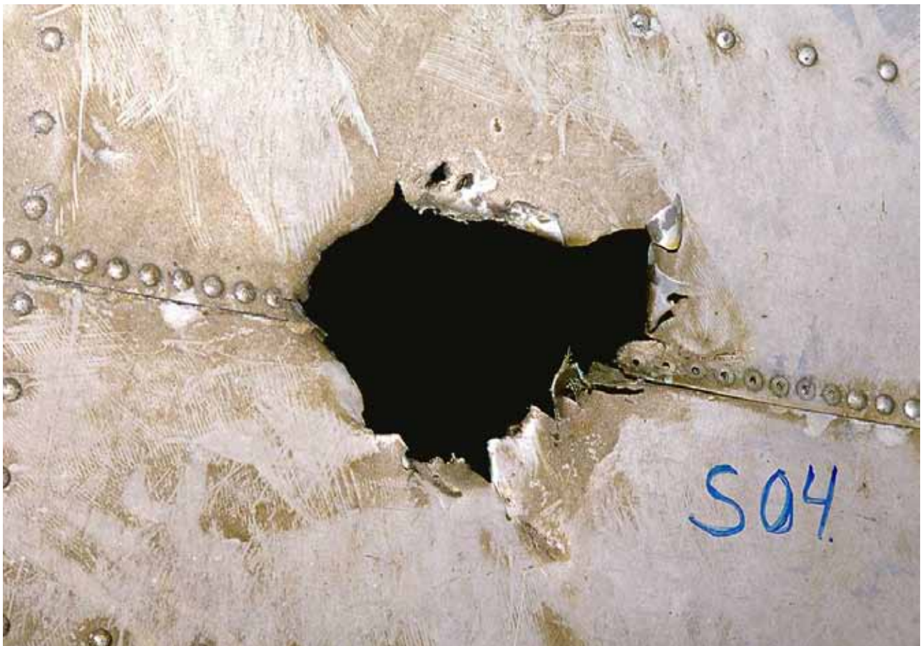
Figur 11 Detalj, brisadskada S04 utifrån
