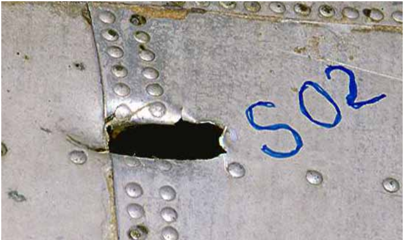
Figur 8 Detalj, ingångsskada S02 utifrån
