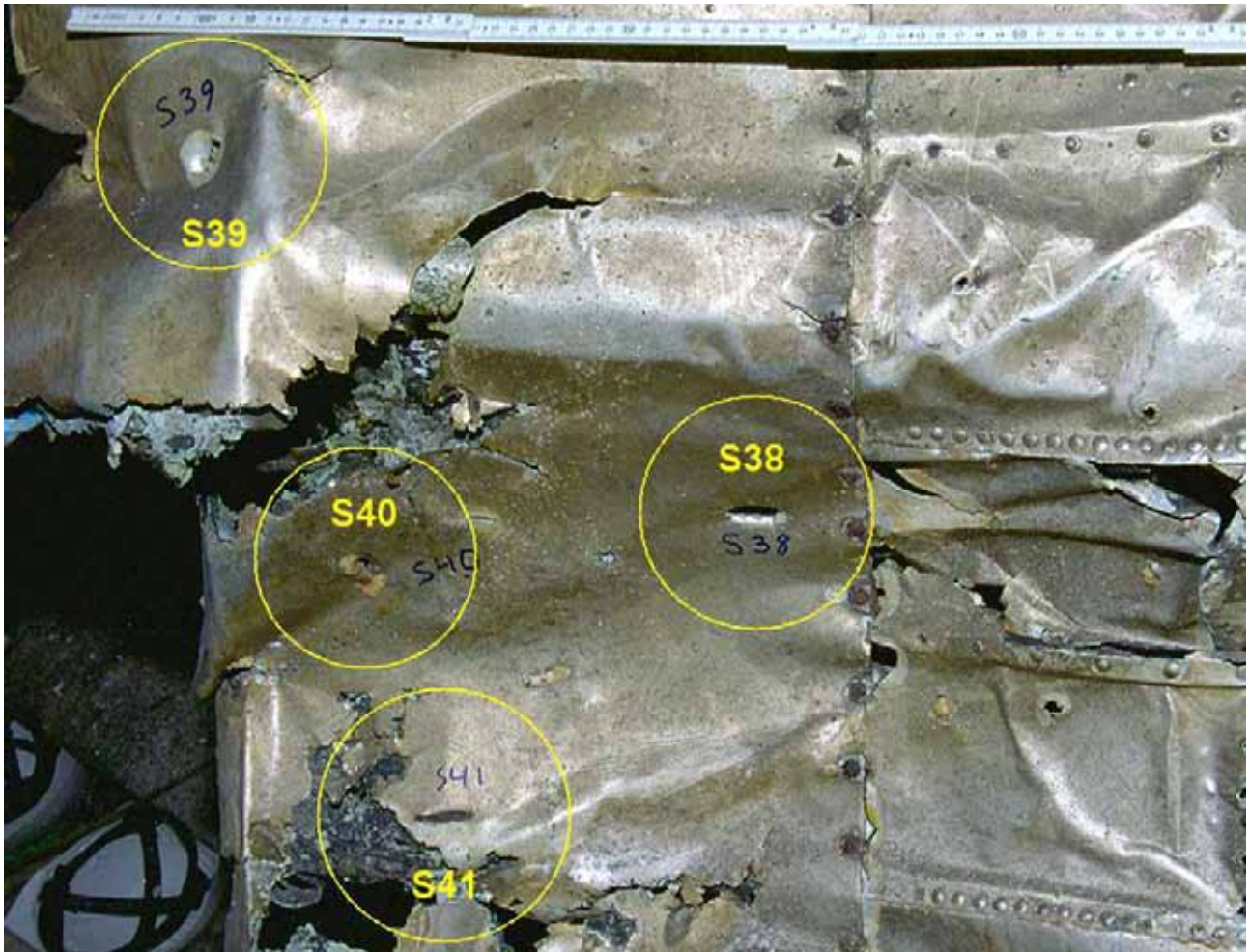
Figur 60 Detalj, splitterskador S38-S41
