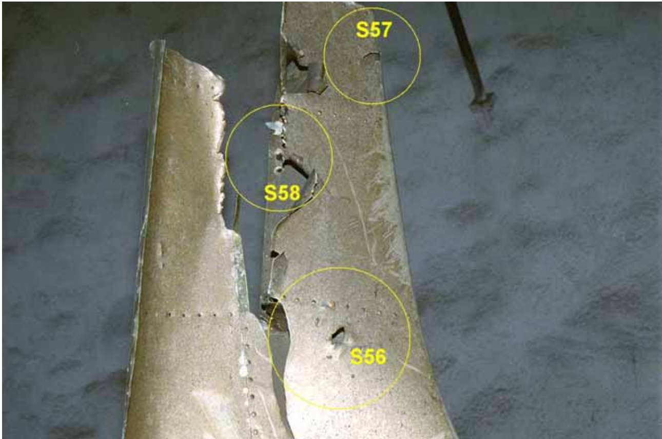
Figur 70 Detalj, utgående splitterskador i fenbas S56-S58
