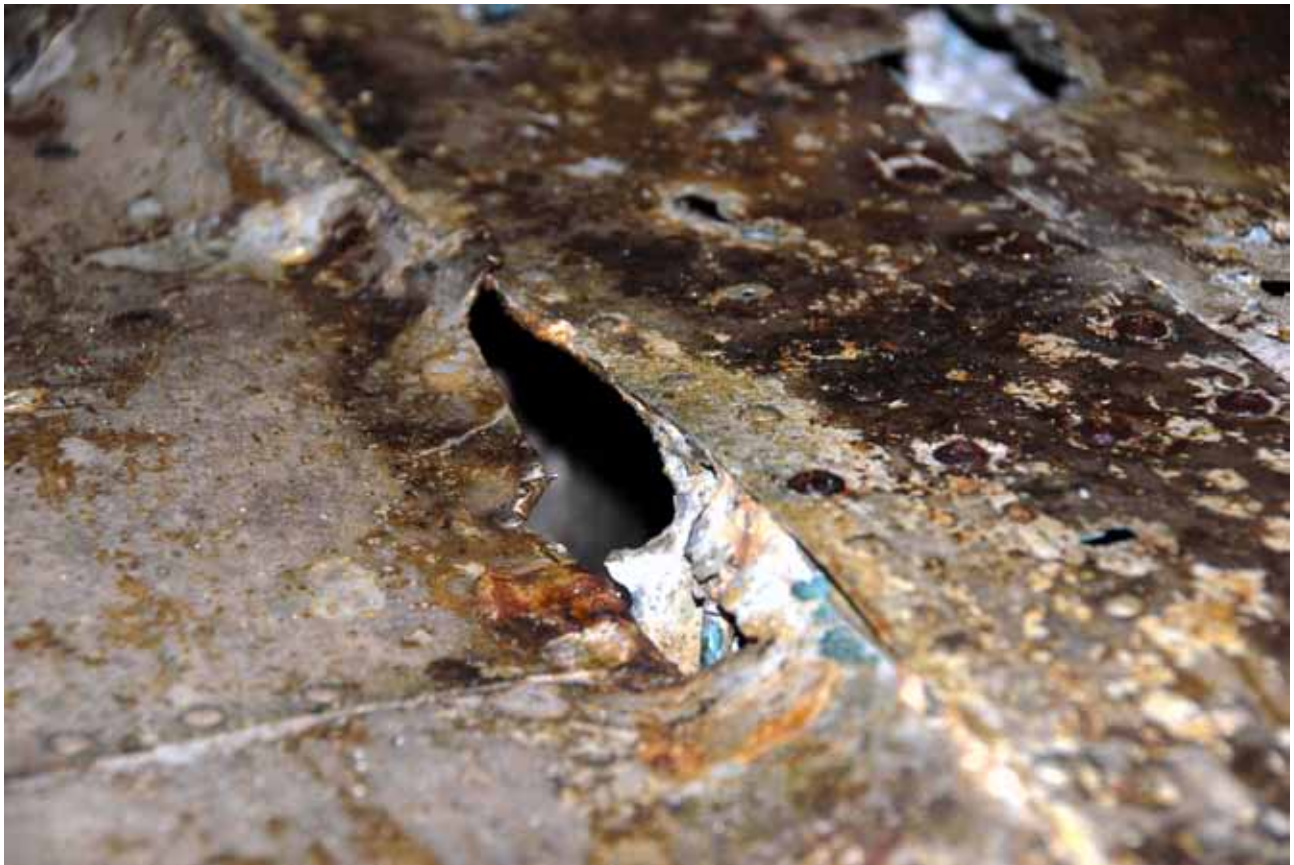
Figur 66 Detalj, sannolikt 23 mm ingångshål S63
