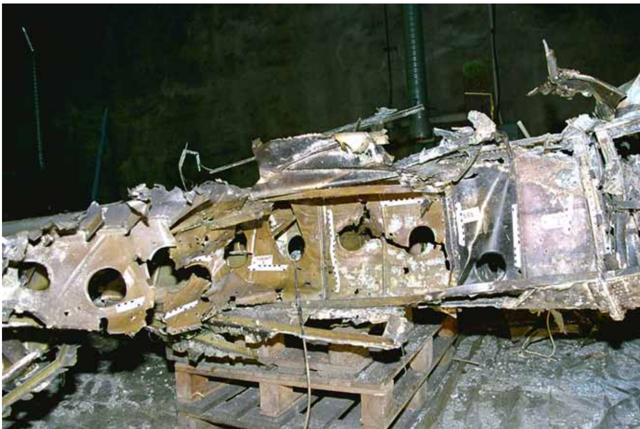
Figur 50 Översikt, splitter- och brisadskador S53 i vänster vinges bakkant
