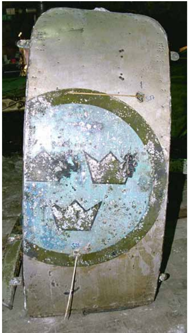
Figur 32 Splitterskada S27-S32 i fallskärmsdörrens insida (vb), genomgående splitterskador S27-S28 utifrån (hb)
