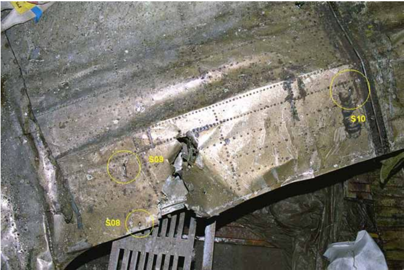
Figur 19 Splitterskador S08-S10 i höger innervings ovansida (den större plåtskadan till höger om S08 och S09 uppkom av lyftremmarna under bärgningen)
