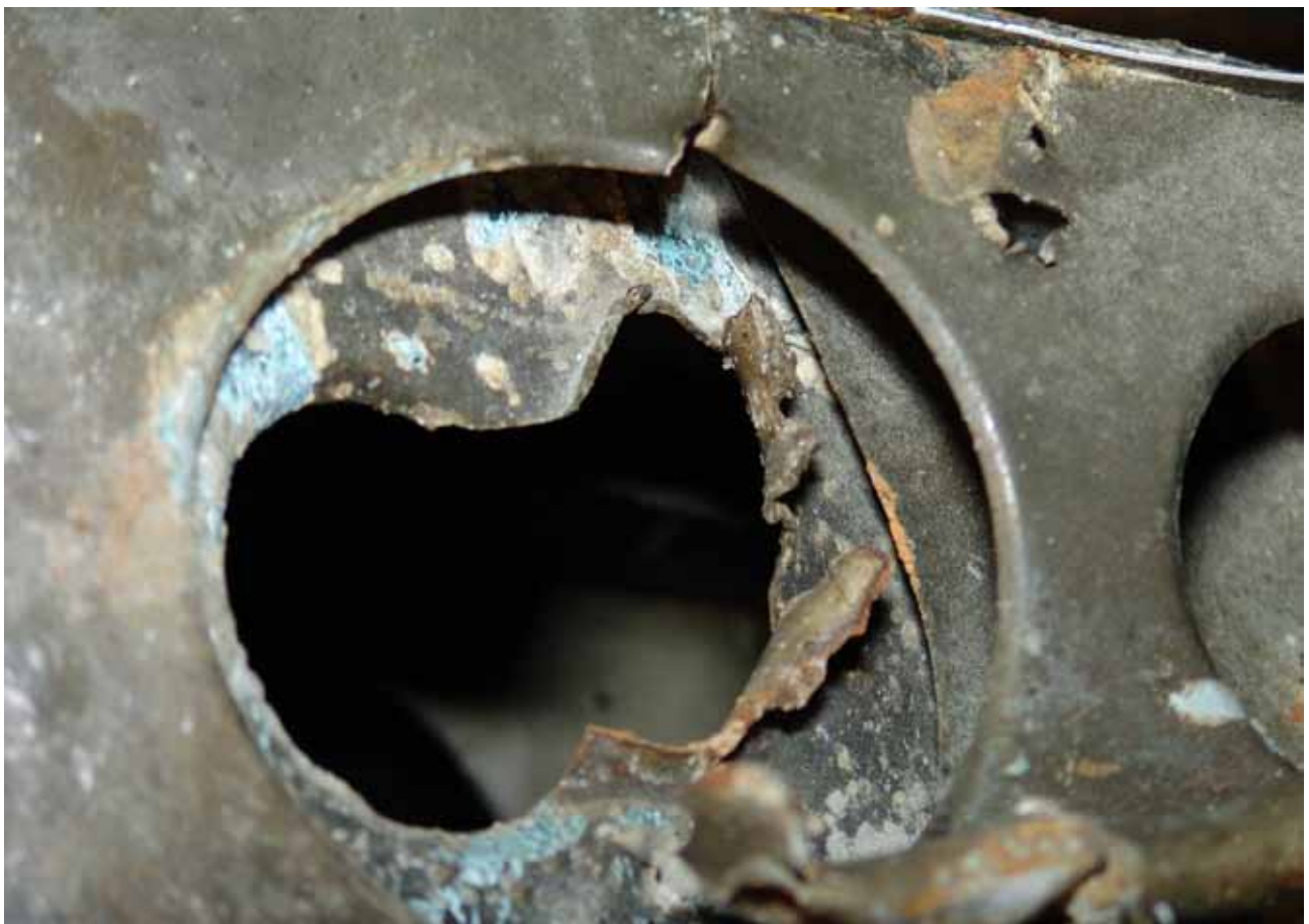
Figur 67 Detalj, inre skada i fenbas (sett framifrån) sannolikt härrörande från 23 mm pansarbrandprojektil som träffat i fenbasens högra bakkant (S63)
