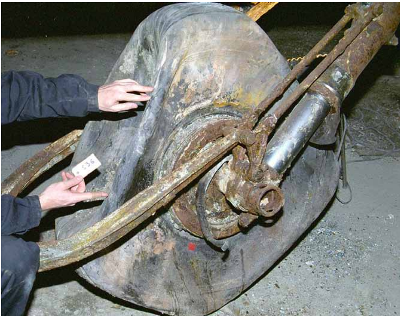
Figur 42 Splitterskada S36A, S36B, höger landningsställ (däck punkterat)
