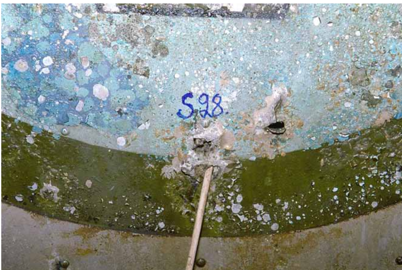
Figur 34 Detalj, splitterskada S28 (utträde)
