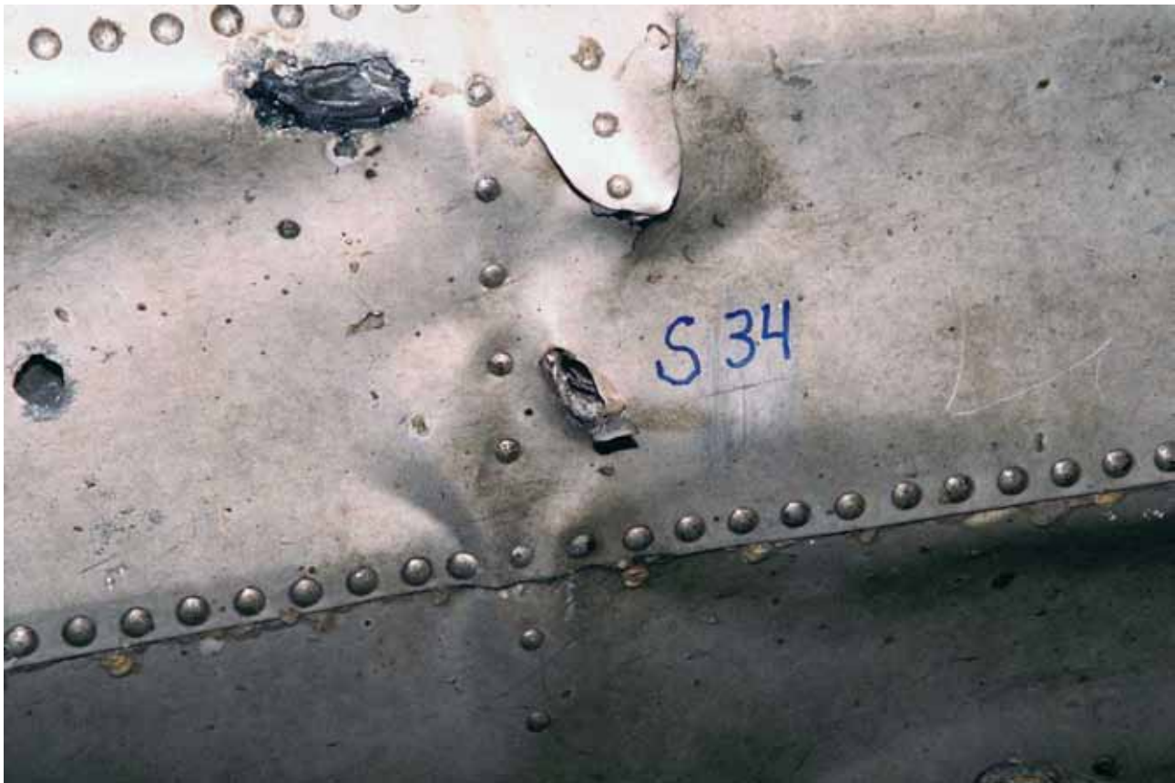
Figur 40 Detalj, splitterskada S34
