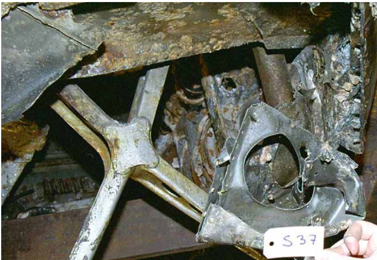
Figur 46 Ytterligare splitterskador S37 bakom höger hjulhus (sett bakifrån)
