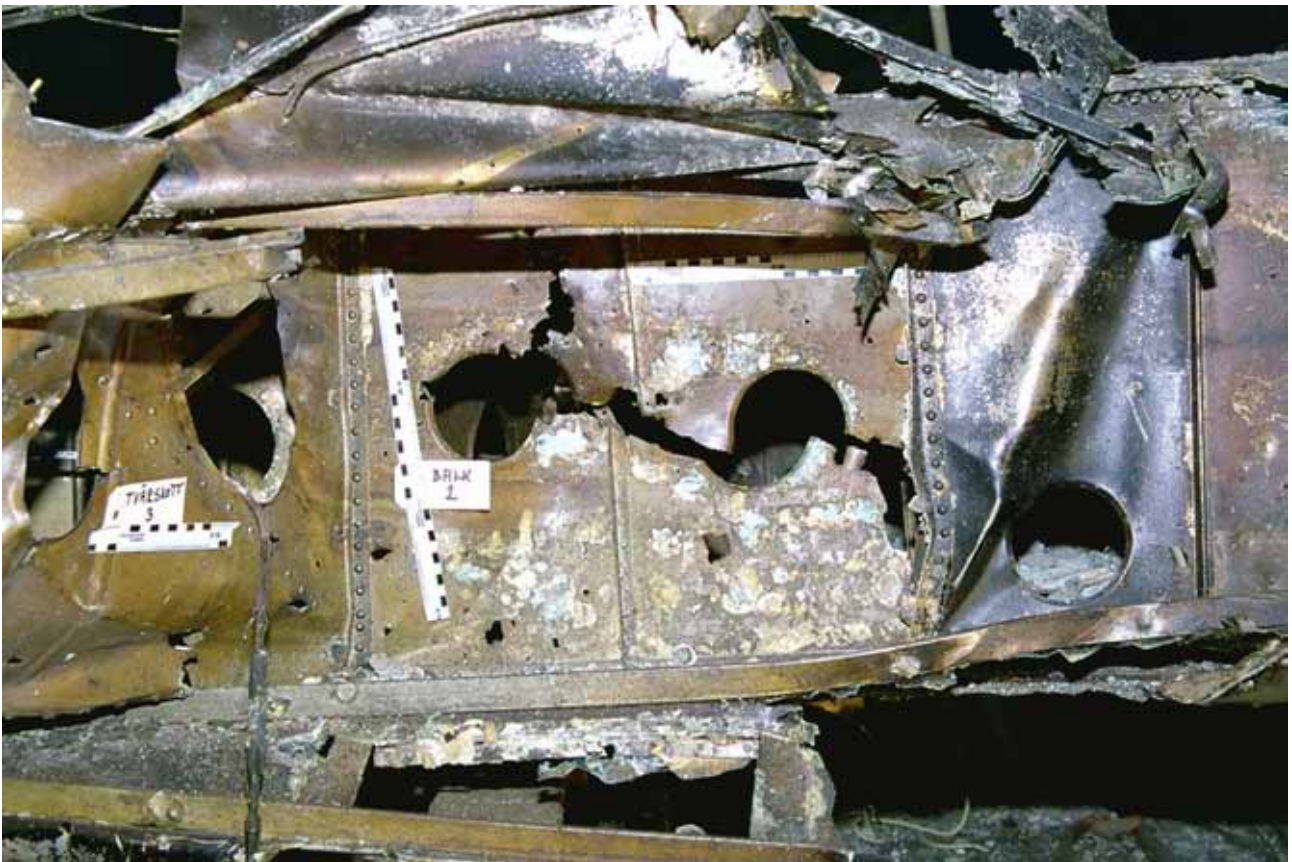
Figur 53 Detalj 3, splitterskador S53, vänster vinges bakkant
