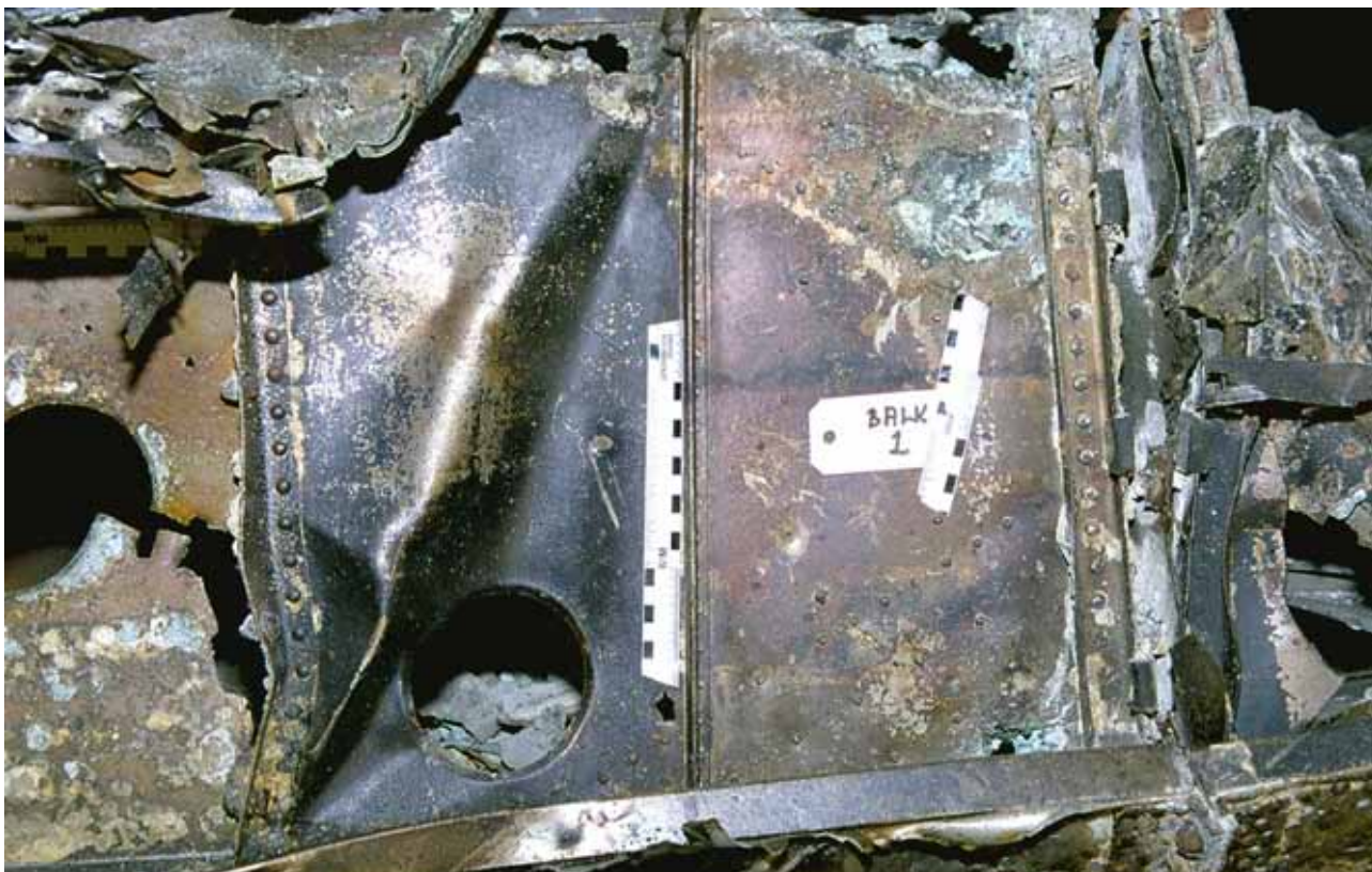
Figur 54 Detalj 4, splitterskador S53, vänster vinges bakkant
