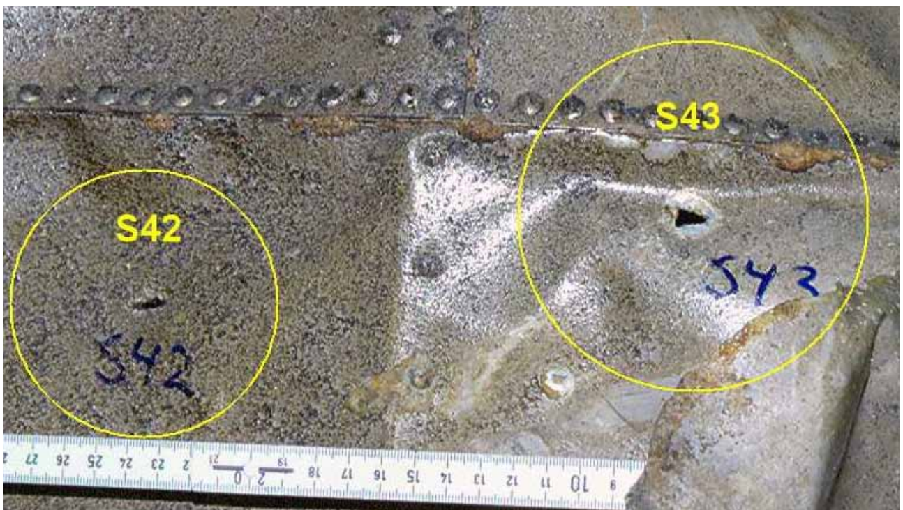
Figur 61 Detalj, splitterskador S42-S43
