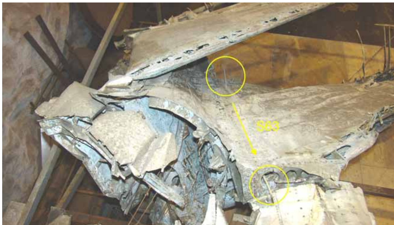
Figur 65 Översikt framifrån, sannolik träff av 23 mm pansarbrandprojektil som passerat genom hela fenbasen (plaströr indikerar skottkanal i fenbas)
