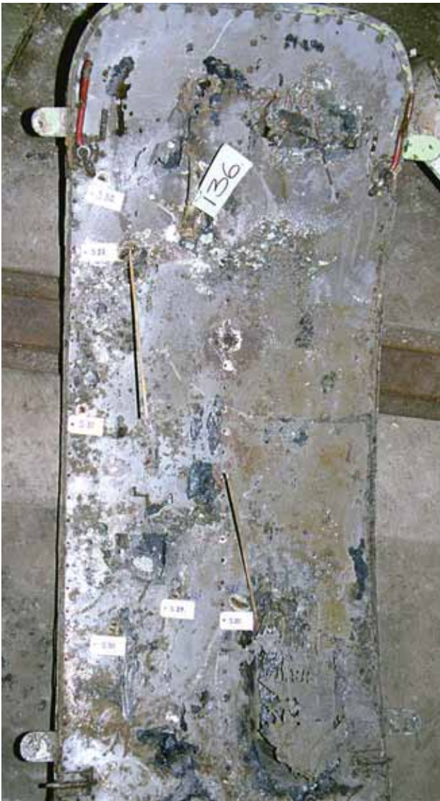
Figur 32 Splitterskada S27-S32 i fallskärmsdörrens insida (vb), genomgående splitterskador S27-S28 utifrån (hb)
