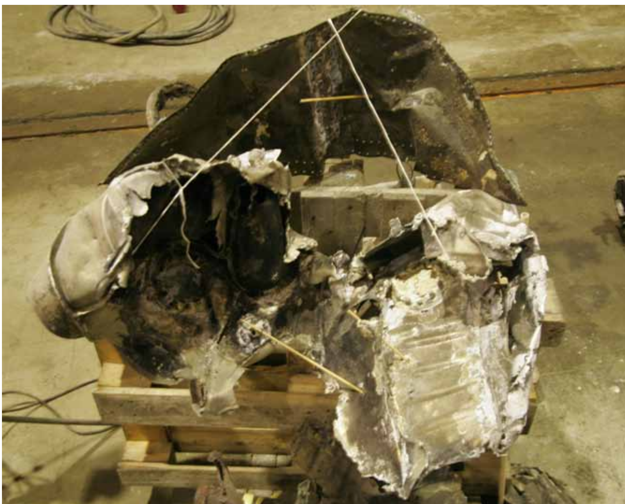
Figur 55 Vänster oljetank, sannolik brisadskada och källa till brand i vänster innervinge
