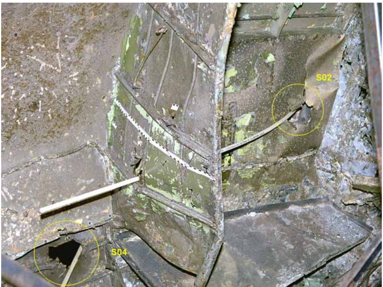
Figur 9 Brisadskada S04 i ytterplåt och S02 i inre plåt sedda inifrån, främre toalettvägg centralt i bilden
