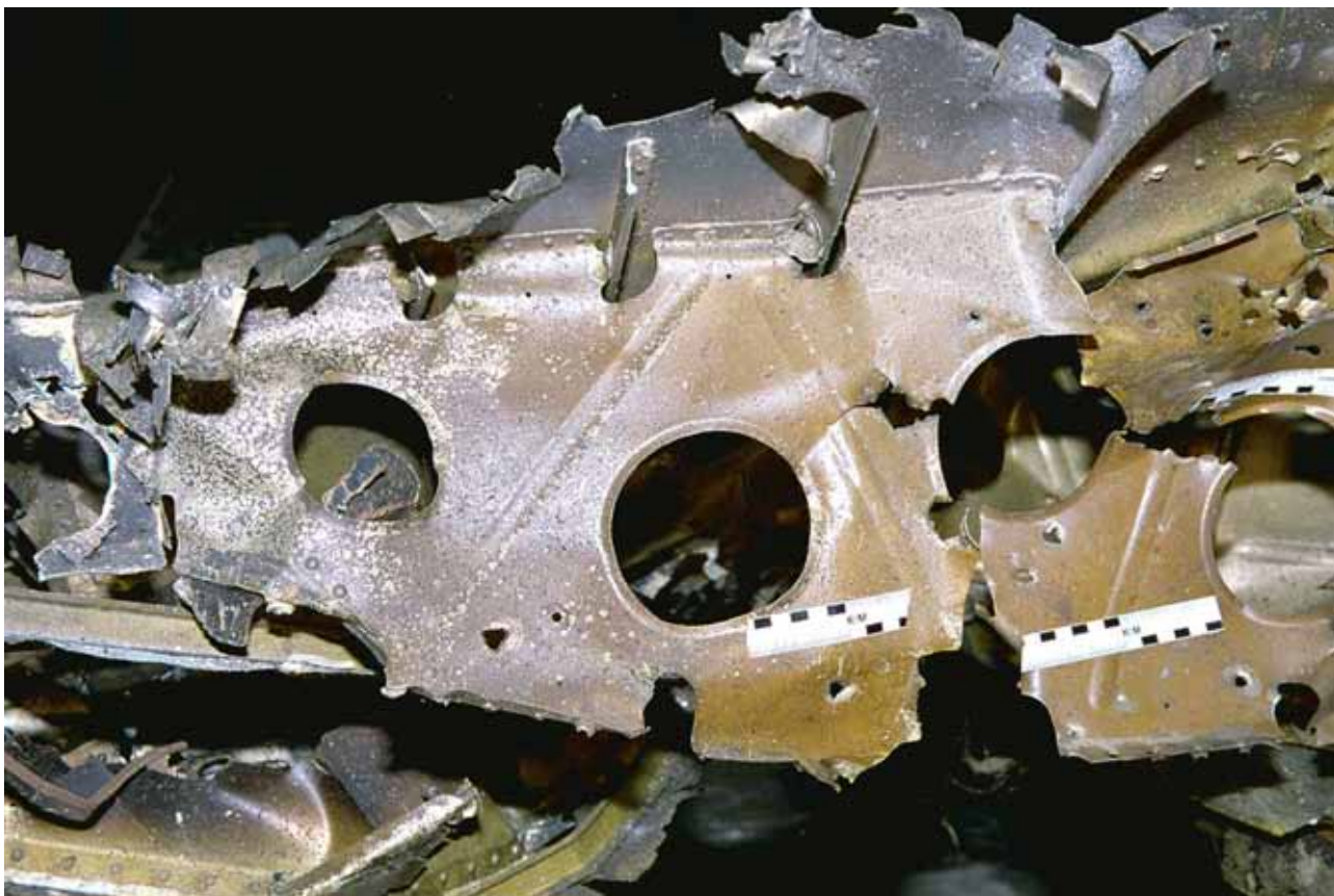
Figur 51 Detalj 1, brisadnära splitterskador S53, vänster vinges bakkant
