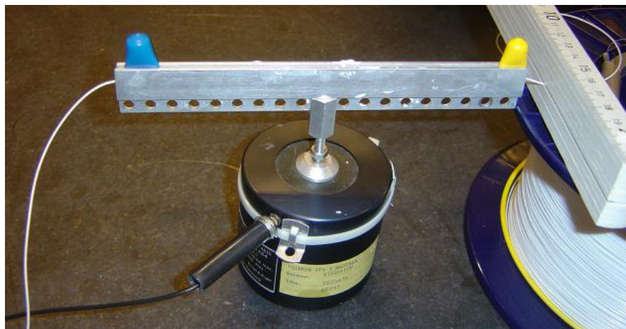
Figur 7.3 En vibrator böjer fibern med en högre frekvens och en mindre amplitud
