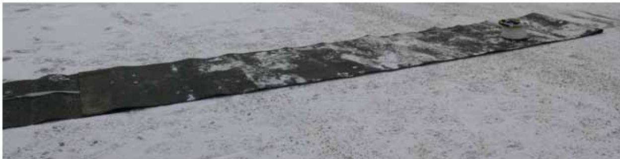
Figur 7.6 Sensorfibern begravdes under tjärpapp
