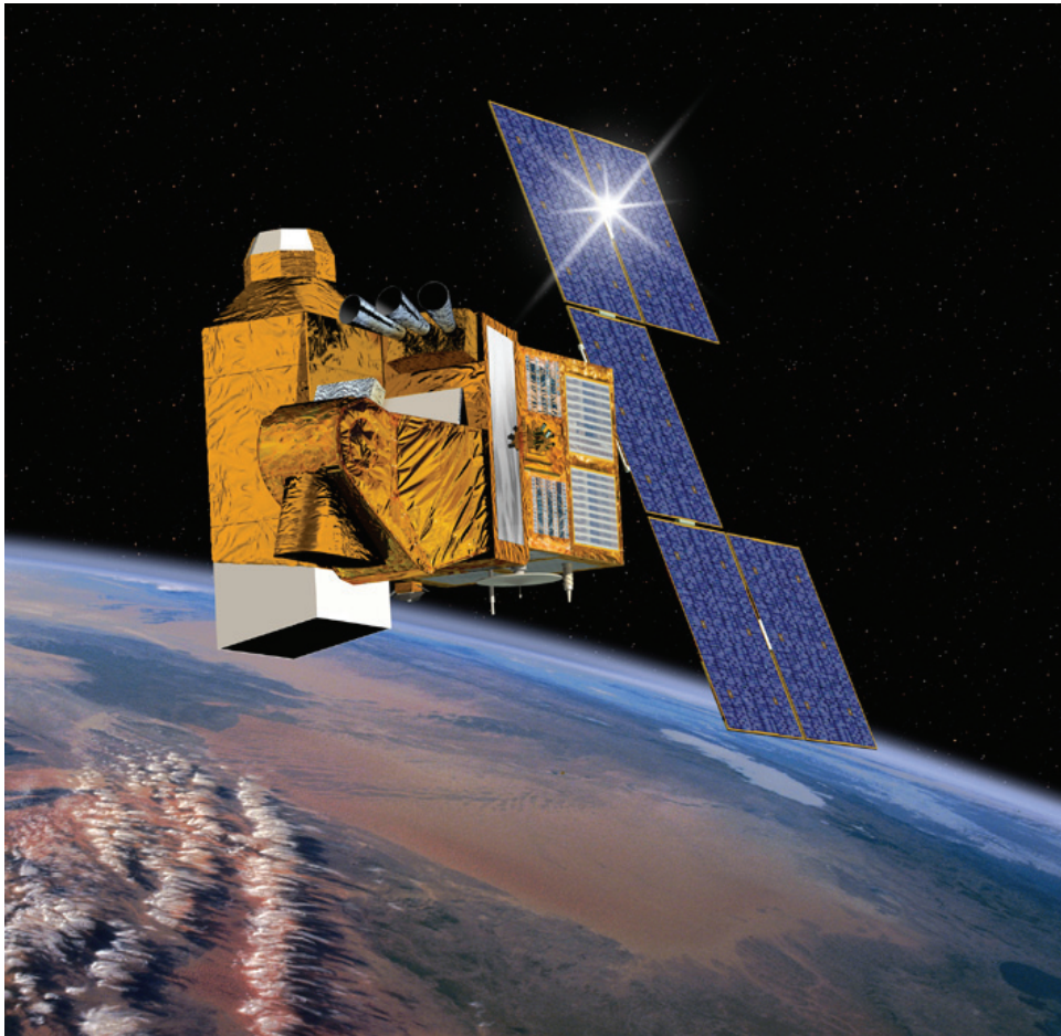
Figur 1: En artists vy av Helios 2A, föregångare till MUSIS. Notera de två olika instrumenten för hög upplösning (vänster) respektive översikt (höger). Helios 2A skickades upp 2005. Bildrätt: CNES/Activ Design, 2004 25
