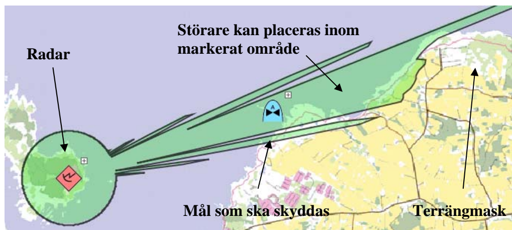
Figur 6 Täckningsdiagram för placering av radarstörare för att gömma ett mål.
