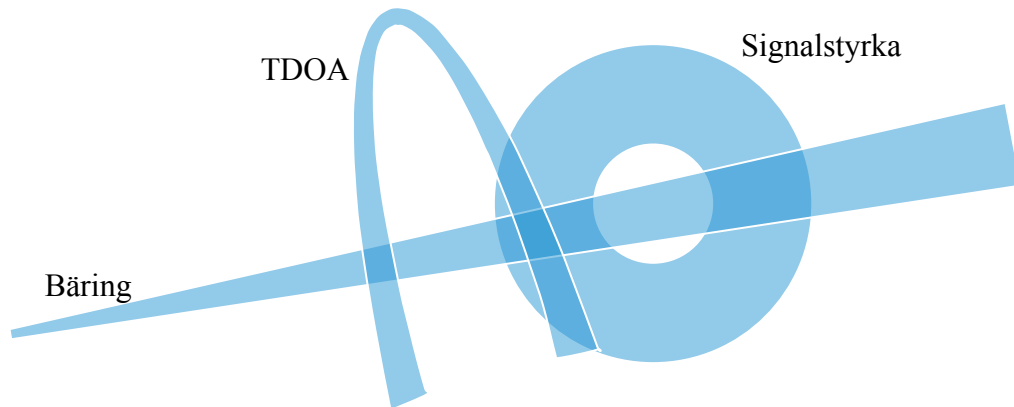
Figur 45 Sammanslagning av sannolikhetsfördelningar från olika signalspaningssystem.
