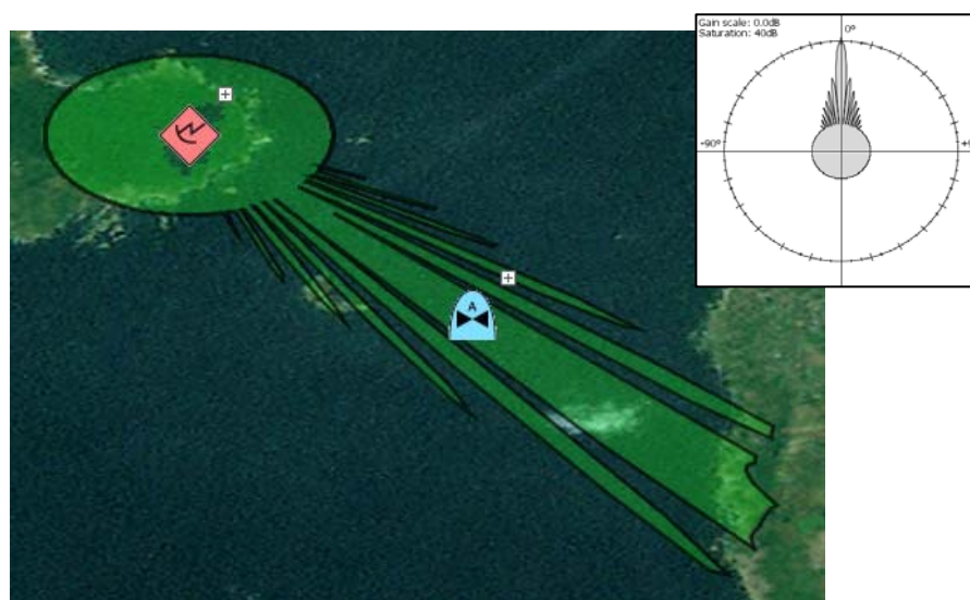
Figur 7 Visar yttäckning för placering av störare då radarsensorn har en antenn av rectangular lobe typen (se diagram). Kartan som används är en satellitkarta i lat-long format från NASA.
