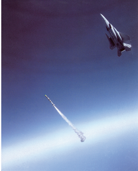
Figur 1 En ASAT-robot skjuts från ett F-15 Eagle flygplan under ett test 1985. Källa: Amerikanska flygvapnet.
