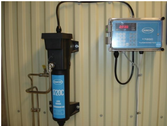
Turbiditetsmätare vid Forslunda vattenverk i Umeå
