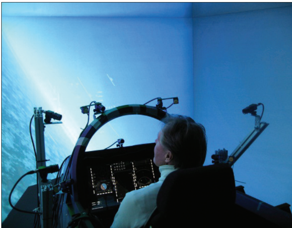
Figur 8: Monteringen av kamerorna i en av FLSC pilotstationer.
