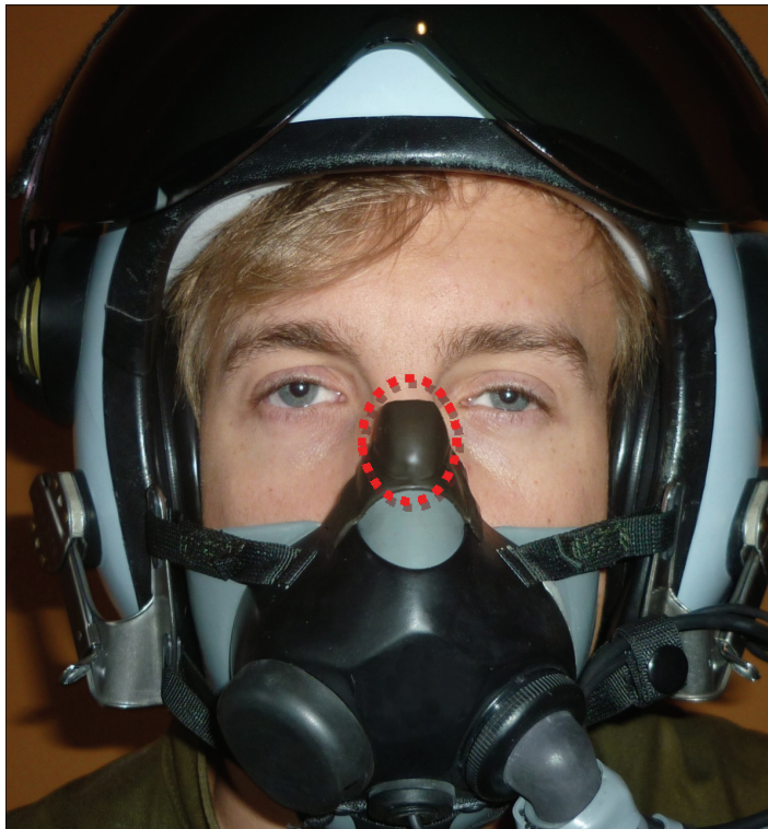
Figur 16: Utkast på lösning med två miniatyrkameror monterade nära ögonen. Den streckade röda ovalen markerar den förväntade extra modulen på masken. I denna modul finns två kameror av den storlek som syns i figur 17.
