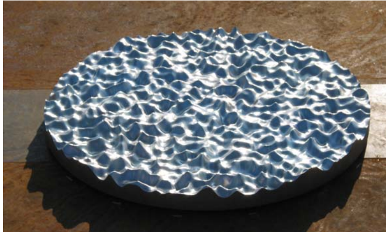
Figur 1. En bild av den skrovliga referensytan som används som objekt vid radarmätningarna. Diametern på ytan är 0.9 meter.
