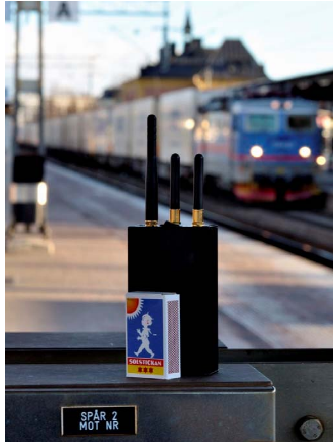
Figur 3: GPS-störsändare som säljs via Internet. Fotot taget av Mikael Alexandersson, FOI.
