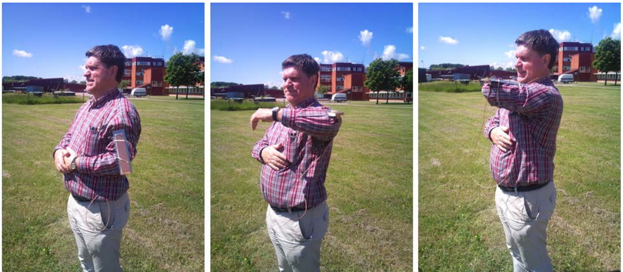
Figur 9: Valideringsmätningar av textilintegrerad antenn. Antennen är fäst vid försökspersonens överarm.
