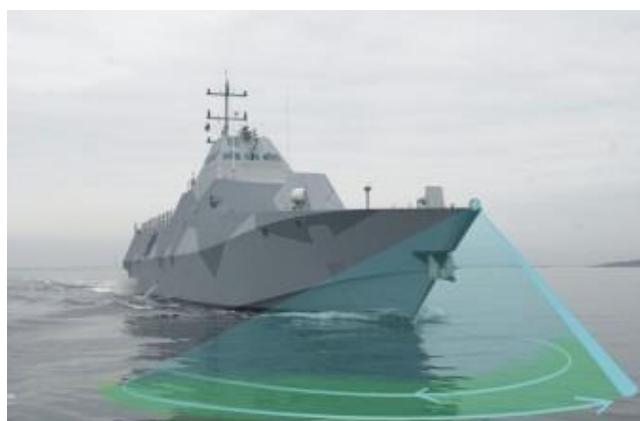
Figur 19: Mätprincip för fartygsburen lidar för detektion av ytnära undervattensmål. Bild: FOI.
