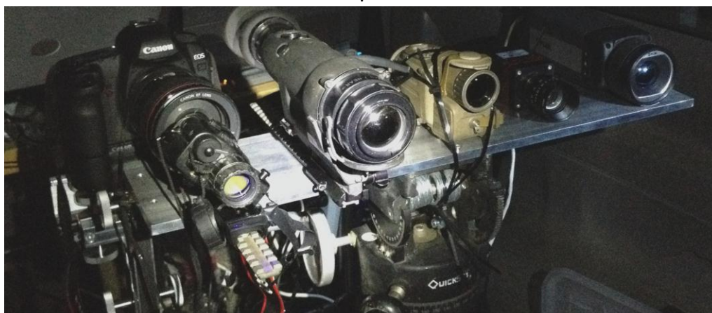
Figur 12: De fem olika sensorerna placerade på det justerbara bordet. Från vänster till höger: bildförstärkaren Mono 12, IRV-siktet MTWS, IRV-siktet CQB, Raptor-kameran (SWIR) samt A655SC (LWIR).
