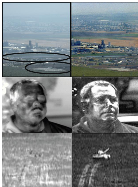
Figur 29: Exempel på tillämpningar för polarimetrisk avbildning. (övre) siktförbättring i VNIR-området, (mitten) ansiktsgenkänning samt (nedre) kontrastförbättring i det termiska bandet. Källa: [12]
