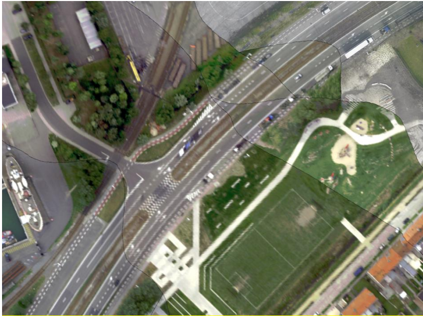
Figur 18. En illustration av uppnådd noggrannhet i georeferering där fem olika hyperspektrala bilder georefererats och som referens överlagrats på ett ortofoto som syns längst upp till höger.
