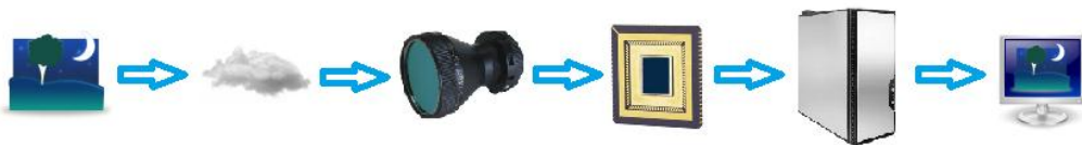
Figur 7: Elektrooptisk avbildning är en kedja av fysikaliska fenomen som var och en bidrar till den kontrast, skärpa och brus som upplevs i en bild för en mänsklig operatör.
