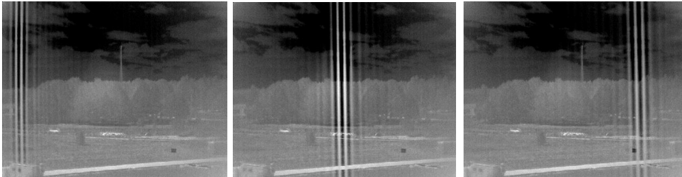
Figur 23: I en spegeltranslaterande mod förflyttas interferensmönstret över en statisk scen mha. en förskjutning av den ena hörnkuben parallellt längs den optiska axeln (mha. motorn implementerad i Figur 21).
