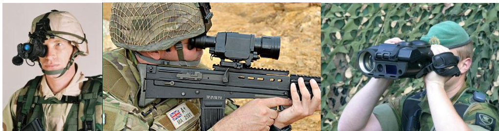
Figur 3: Tre av de dominerade soldatburna mörkersensorerna på moderna slagfältet, här exemplifierat med den amerikanske monokulära gen3-bildförstärkaren PVS-14 (vänster), det termiska okylda mikrobolometer-baserade vapensiktet DRAGON-MR från Qioptiq (mitten) samt det kylda skannande MCT-baserade kikarsystemet SOPHIE-MF från Thales (höger).
