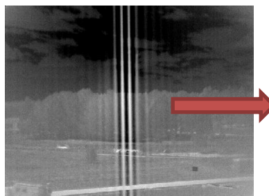
Figur 22: I pushbroom-mod är interferensmönstret fixt i kamerans synfält medan en relativ rörelse mellan scen och sensor (pga. en plattformsrörelse exempelvis) gör att mönstret sveps/skannas över scenen.
