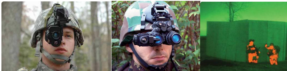
Figur 4: En tydlig trend på senare tid är fusionering av bildförstärkare och termisk IR, här exemplifierat genom det amerikanska ENVG-systemet (vänster) samt det brittiska ClipIR (mitten). Fusioneringen sker optiskt (överlagras på varandra) och är tänkt att utnyttja styrkor hos respektive teknik i en fruktbar symbios (t.ex. bildförstärkare för situationsuppfattning och IR för detektion).
