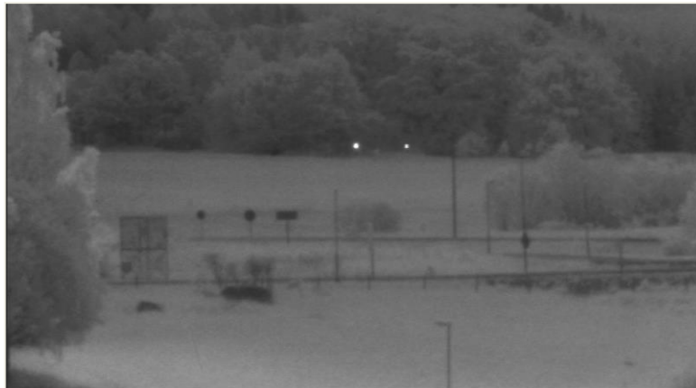
Figur 9. Kikarsikten riktade mot mätsystemet framträder som tydliga lysande punkter med ett avbildande optikspaningssystem.
