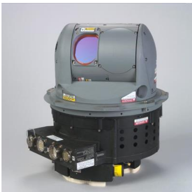
Figur 14 Bild på NEMESIS-systemet som idag är operativt på flera plattformar och finns i några olika varianter med avseende på pekhuvud och lasersystem. Källa: Northrop-Grumman[10].
