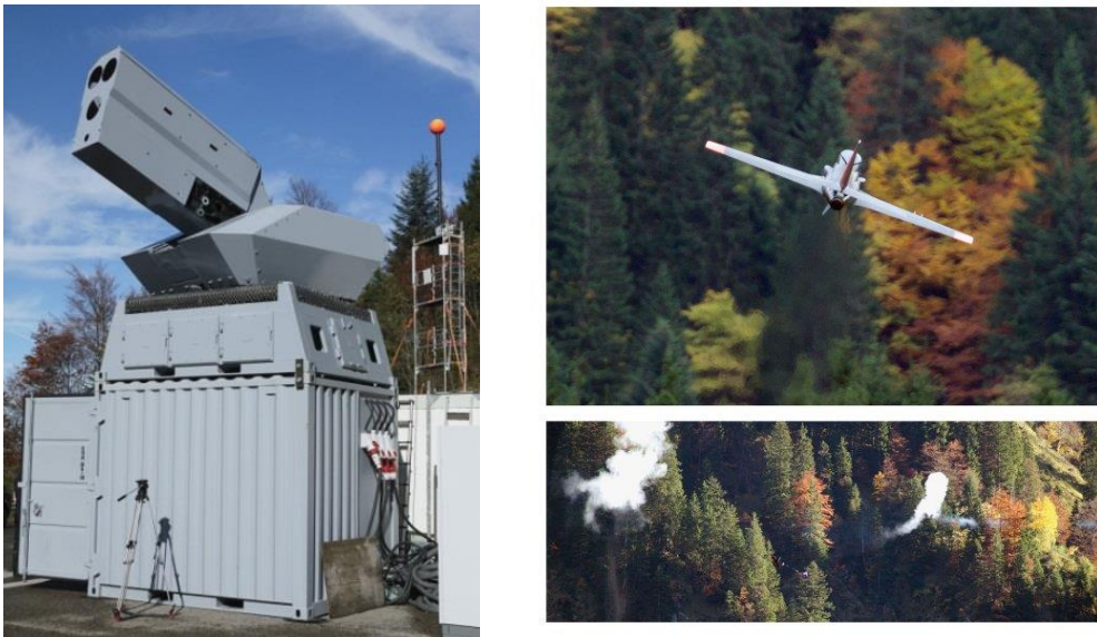
Figur 17 Demonstration av ett 30 kW taktiskt laservapen som tagits fram av tyska Rheinmetall. Här visas hur en UAV bekämpas på ca 1 km avstånd. Källa: Rheinmetall[12].
