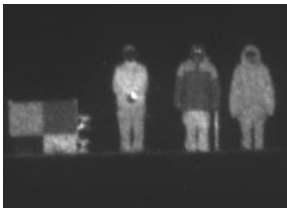
Figur 11. Exempel på en grindad 2D-bild där avståndsluckan lagts så att bara personerna är upplysta och bakgrunden mörk. Eftersom våglängden är 1,55 \mu\text{m} så är färgkontraster annorlunda än i visuellt, till exempel är hud mycket mörk.
