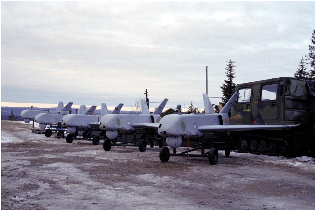
Figur 5. UAV:er, här Ugglan, kan flyga framför en konvoj och kan utrustade med laserbaserade sensorer upptäcka även hot som är dolda under vegetation. Foto Försvarsmakten, fotograf Bengt Eriksson
