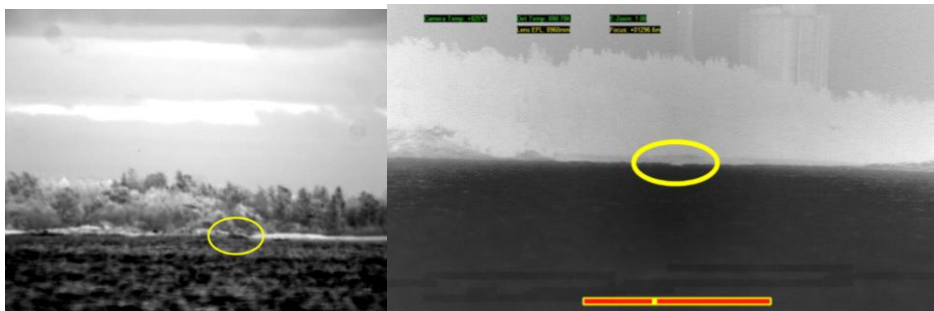
Figur 3. Bilder av båt A vid 6 km avstånd sedd mot landbakgrund. T.v. en passiv SWIR bild (Raptor) och t.h. en bild från Horizon kameran (MWIR).
