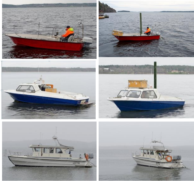
Figur 1. Målbat. De övre båtarnas signatur modifierades genom att placera ett kaminrör och en låda på respektive båt. Båt A (övre): längd 4.73 m, bredd 1.92 m. Båt B (mitten): längd 6.18 m, bredd 2,15 m (total längd inkl. bakre platta = 6.57 m). Båt C (undre): längd 8.64 m, bredd 3.15 m (total längd inklusive bakre platta = 9.55 m).
