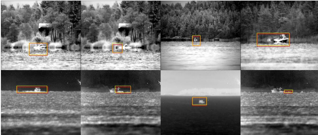
Figur 11. Markeringsramar för detektion i sekvenser av olika modalitet med mindre goda resultat avseende uppskattning av måldimensioner. I vissa fall innefattar det optiska flödet bogsvall, vågor eller hägringar inom markeringsramen. Även om markeringsramen inte ger rätt måldimension vid rådande betraktningssvinkel så kan den väl tjäna som invisning t.ex. för ett lasersystem.
