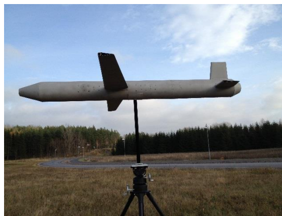
Figur 15. Missilattrapp. Längd 3450 mm, diameter 300 mm vingspann 3000 mm. Avstånd från nos till främre vingar 1300 mm.
