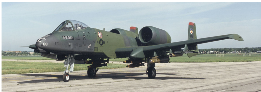
Figur 7: A-10 med Triple Ejector Racks på de inre balkplatserna på vingarna, och med tre lätta bomber på varje rack. Kanonens mynningar sticker fram nere till vänster om planets nos. Foto: Wikimedia Commons/USAF Museum
