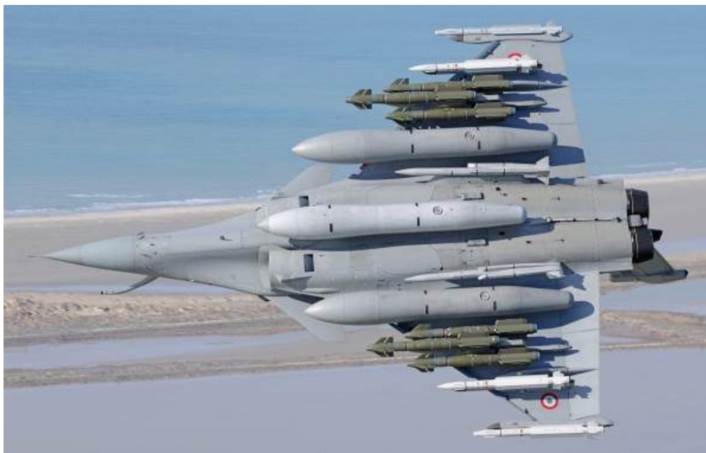
Figur 5: Fransk Rafale med sex HAMMER styrda markmålsvapen, sex jaktrobotar och tre fälltankar. Foto: Dassault
