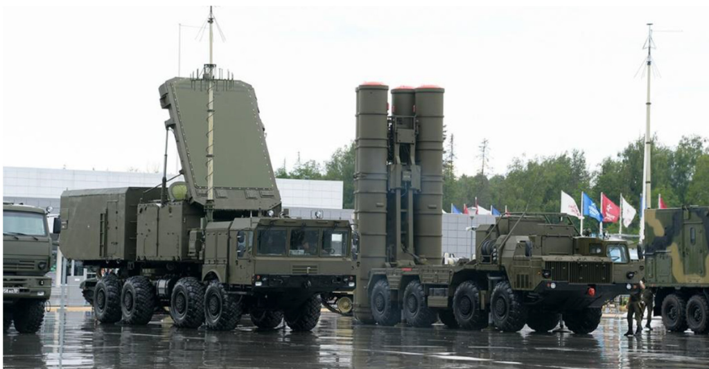
Figur 2: Delar ur ett S-400-batteri. Eldlednings/belysningsradarn 92N6 Grave Stone till vänster, lavett med fyra robotar till höger. Foto: Wikimedia Commons/ Mil.ru
