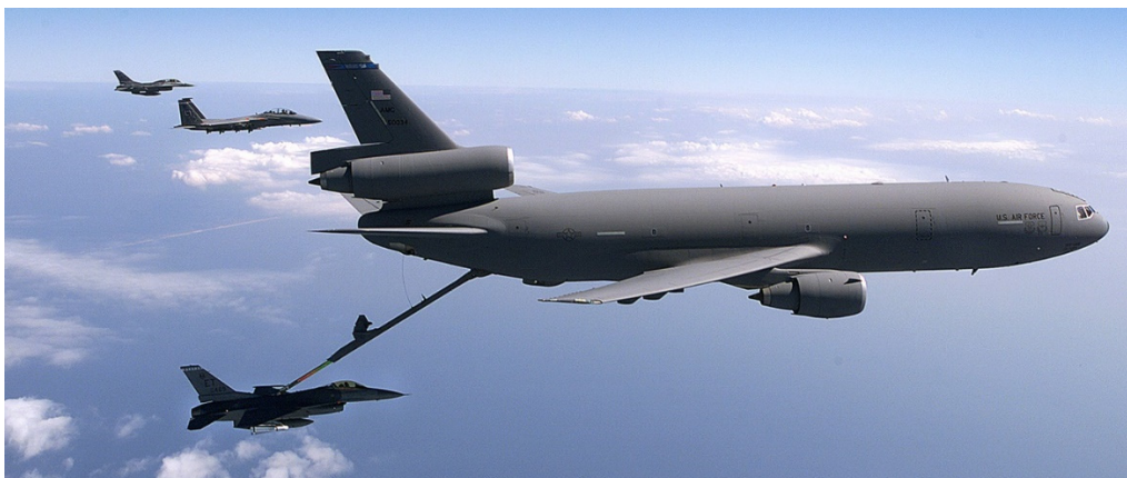
Figur 4: Ett amerikanskt KC-10 tankflygplan fyller på en F-16 medan en F-15 och en F-16 väntar. Foto: Wikimedia Commons
