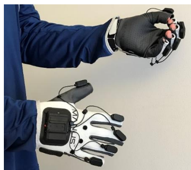
Figur 5. Buret motion capture-system för händer. De synliga sladdarna och enheterna på fingrarna är för haptiska taktorer
