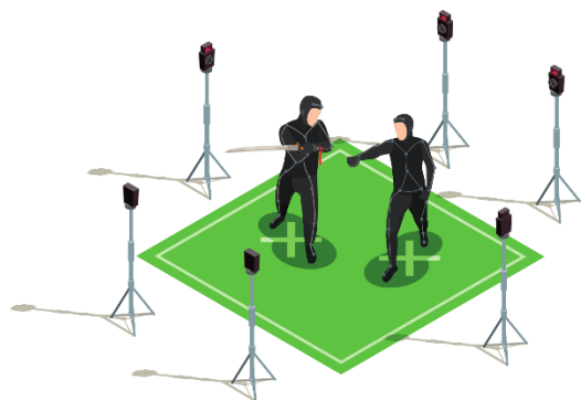
Figur 4. Illustration av en motion capture-system där ett flertal kameror registrerar rörelser och omvandlar det till s.k. skelett-modeller. Bildkälla: Shutterstock.
