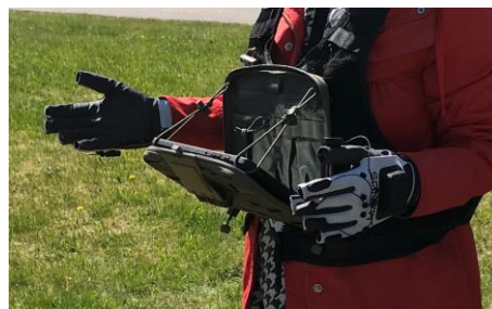
Figur 6. Operatör som styr UGV och som har en datorplatta på bröstet som visar en bild från UGV:ns kamera.
