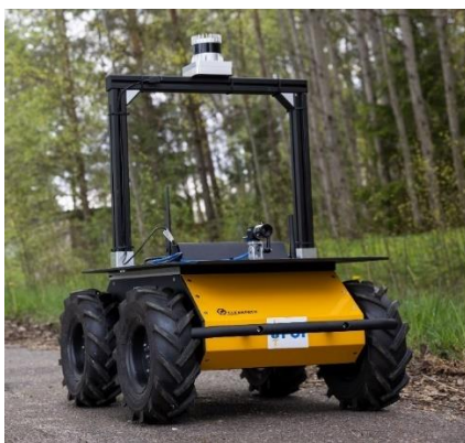
Figur 5. UGV med en framåtriktad kamera. Högst upp sitter en lidarsensor monterad, men denna användes inte i det aktuella testet.
