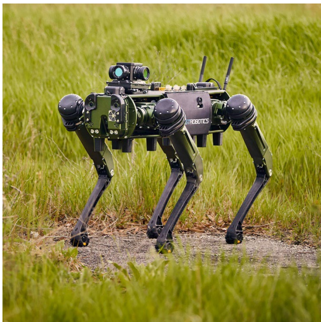
Figur 14: Den biomekaniska hundliknande roboten Ghost Robotics Vision 60 Q-UGV, ett exempel på robot designad för att minska riskerna för egen personal. Foto Ghost Robotics Vision 60 Q-UGV, återgiven med tillverkarens tillstånd.
