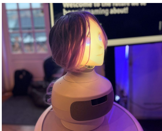
Figur 4: Ett exempel på en social robot som getts ett fysiskt uttryck. Bilden visar roboten Furhat 9 , som kan enkelt förses med olika "huvuden". Foto: Zackarias Alenljung.
