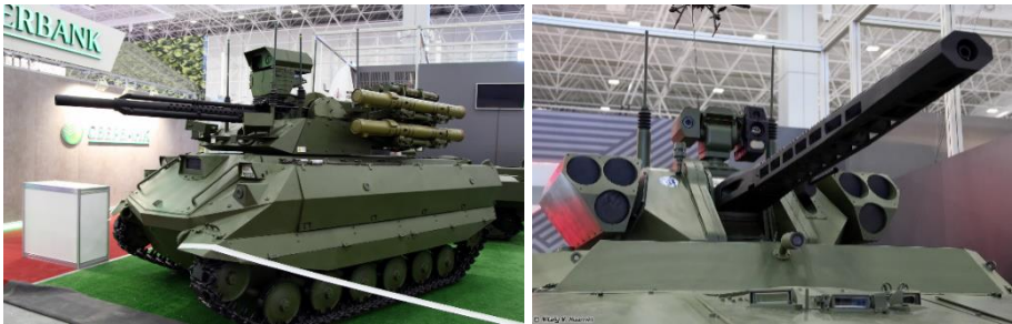
Figur 5.5: Två tunga ryska UGV:er, Uran-9 och Vikhr. Utvecklingen av denna typ av tungt beväpnade UGV:er pågick framförallt före Rysslands storskaliga invasion av Ukraina (foto: Vitaly Kuzmin, Wikipedia).
