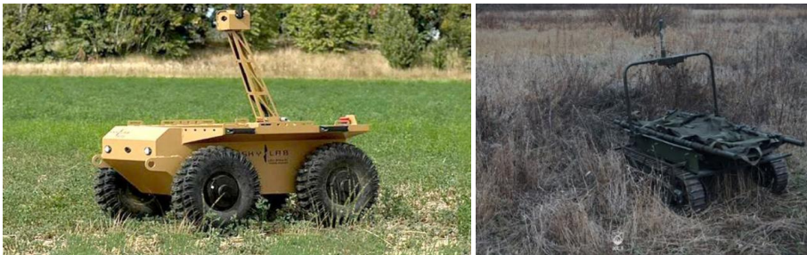
Figur 5.2: Höger – Två exempel på ukrainska UGV:er, Sirko-S1 (vänster), utrustad med EO/IR-sensorer för spaning och med ”följ-mig” funktion, och Volya-E (höger) utrustad med en enkel bår (foto: armyinform.com.ua, CC-BY 4.0). 62,63
