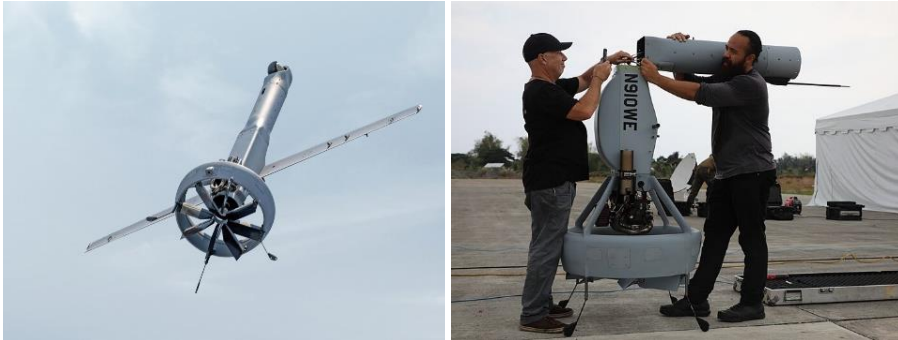
Figur 3.4: Shield AI V-BAT (MQ-35A). Den kan monteras och handhas av två operatörer och kan starta och landa vertikalt på rörliga plattformar såsom fartyg. (foto: vänster – Lilykhinz, Wikipedia; höger – Cpl. Quince D. Bisard, U.S. Marine Corps, Wikipedia).
