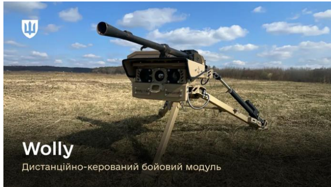
Figur 6.1: Wolly, en vapenstation med automatiserad ballistikberäkning och möjlighet att detektera och följa mål. Den kan användas som en stationär fjärrstyrd vapenstation eller placeras på en UGV (foto: armyinform.com.ua, CC-BY 4.0, bilden är beskuren). 74
