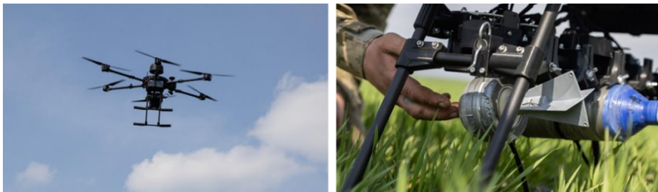
Figur 3.9: Ukrainsk Vampire UAV med sex rotor (hexakopter). Ett exempel på multirotor-UAV som genomför bekämpning genom bombfällning (foto: armyinform.com.ua, Wikipedia).
