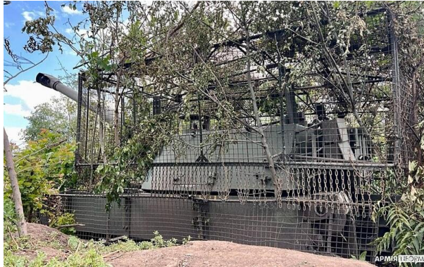
Figur 3.11: Exempel på modifikationer som skydd mot attacker från FPV-UAV:er – en M109A4 155 mm Howitzer som utrustats med heltäckande skydd i form av galler/nät och kedjor (foto: ukrainainform.com.ua, Wikipedia).
