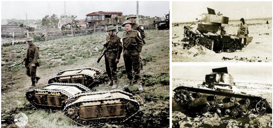
Figur 5.7: UGV:er som användes redan under andra världskriget. Goliath (vänster), en tysk "kamikaze" UGV som fylldes med sprängmedel, och en rysk Teletank som utrustades med eldkastare (höger). Goliath hade en kabel tillbaks till operatören medan Teletank var radiostyrd (foto: public domain, Wikipedia).
