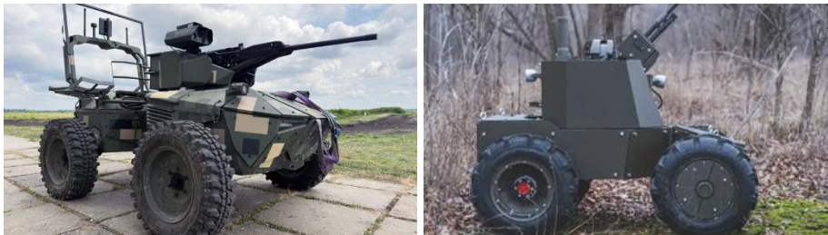
Figur 5.4: Exempel på beväpnade ukrainska UGV:er, Roboneer's Ironclad med en Saber M2 RWS och Lyut (foto: ArmyInform, CC-BY 4.0). 66,67
