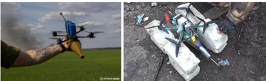
Figur 3.7: Vänster – exempel på en ukrainsk FPV utrustad med RPG-ammunition (foto: armyinform.ukraine.ua , CC-BY 4.0). Höger – en rysk FPV som är utrustad med RPG-ammunition som startar från en provisorisk startplats (foto: mil.ru , Wikipedia).
