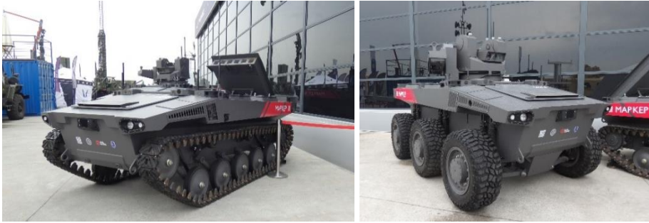
Figur 5.6: Band- och hjuldriven rysk UGV, Marker, från mässan "Armiya 2022" (foto: Kirill Borisenko, Wikipedia, bilderna är beskurna).
